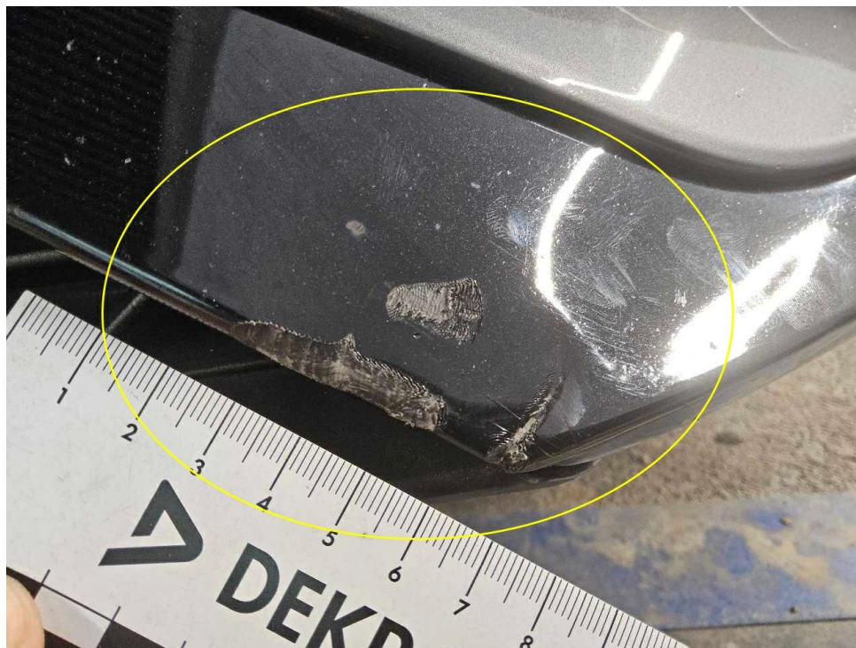
Bild 20 : Schaden Stoßfänger vorne
