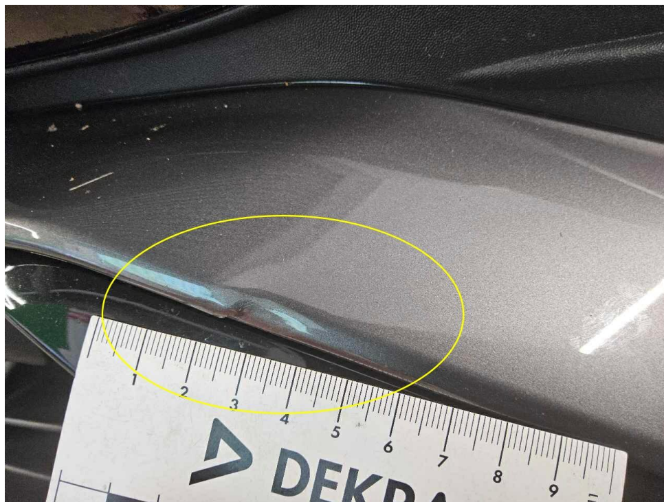
Bild 22 : Schaden Stoßfänger vorne
