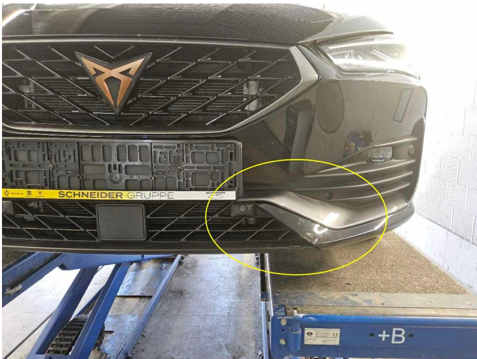
Bild 18 : Schaden Stoßfänger vorne
