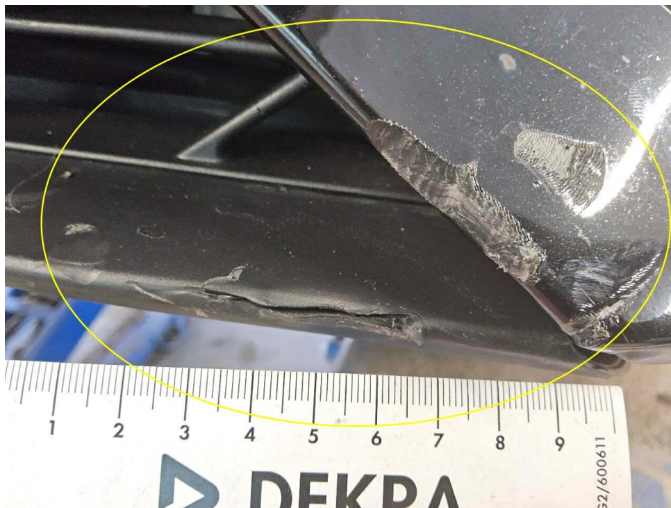
Bild 21 : Schaden Stoßfänger vorne
