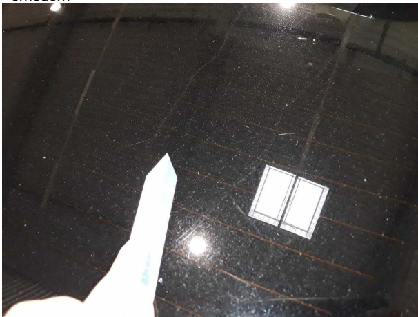
Beschädigung #3: Verglasung: Heckscheibe - verkratzt / versch... - erneuern
