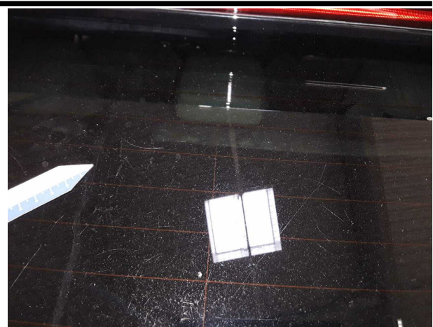
Beschädigung #3: Verglasung: Heckscheibe - verkratzt / verschürft - erneuern
