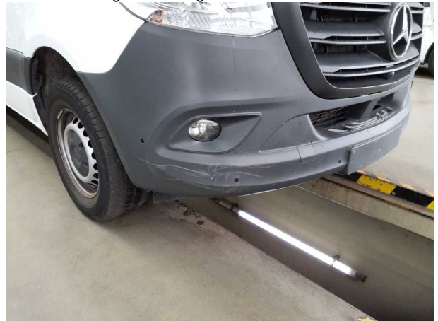
Beschädigung #19: Stossfänger vorn: Stossfänger mit Parktronic... verkratzt / verschürft - erneuern
