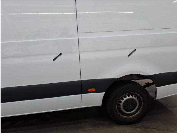
Beschädigung #10: Seitenwand links: Seitenwand - Delle / Lackschaden - Smart Repair
