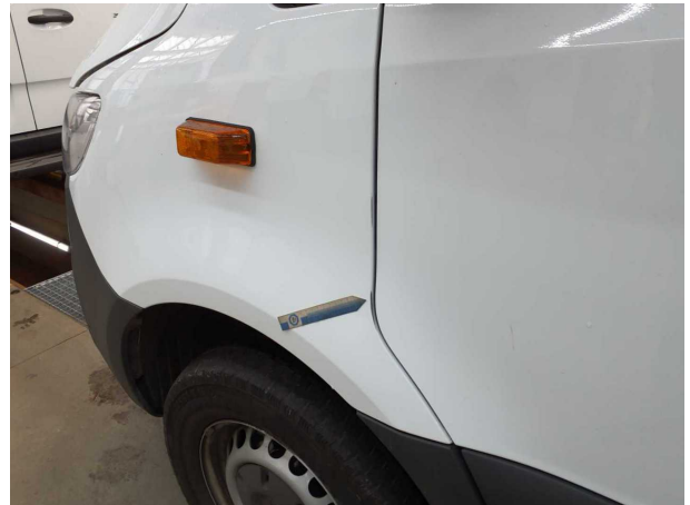
Beschädigung #15: Kotflügel links: Kotflügel links - verkratzt / verschürft - lackieren
