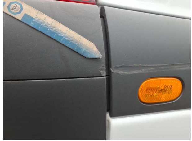
Beschädigung #1: Stossfänger hinten: Abdeckung Stossfänger hinten (Rechts) - Abrieb - erneuern
