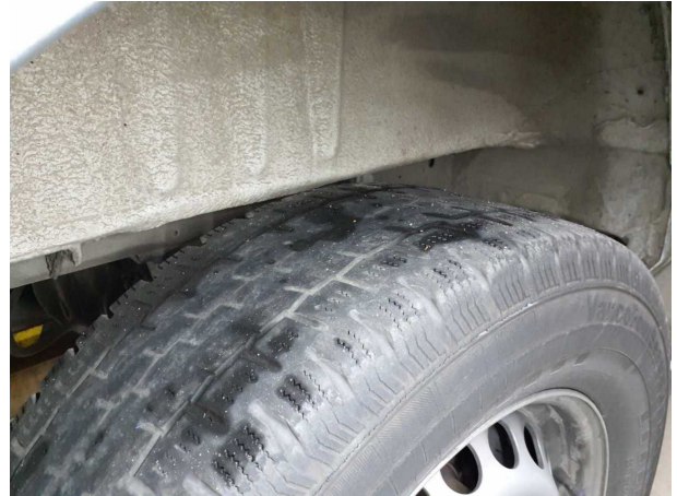
Beschädigung #16: Rad/Reifen: Reifen hinten - verschlissen - erneuern
