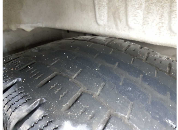
Beschädigung #16: Rad/Reifen: Reifen hinten - verschlissen - erneuern
