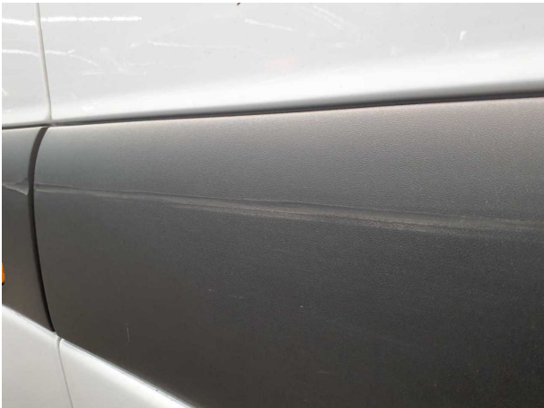
Beschädigung #14: Schiebetür rechts: Zierleiste - Abrieb - erneuern
