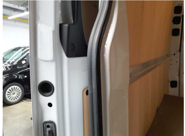
Beschädigung #7: Schiebetür rechts: Türdichtung - gebrochen / gerissen - erneuern
