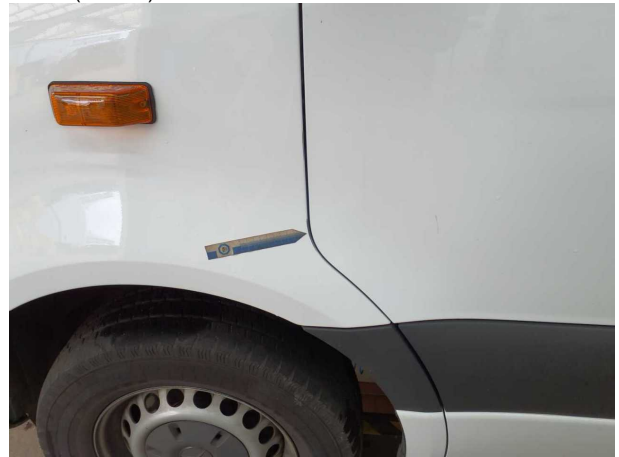
Beschädigung #2: Tür vorn links: Tür - Fehlstellung - einstellen/justieren
