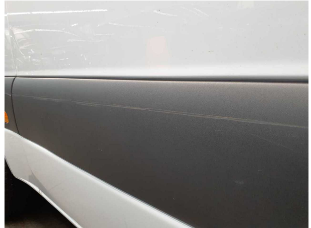
Beschädigung #14: Schiebetür rechts: Zierleiste - Abrieb - erneuern
