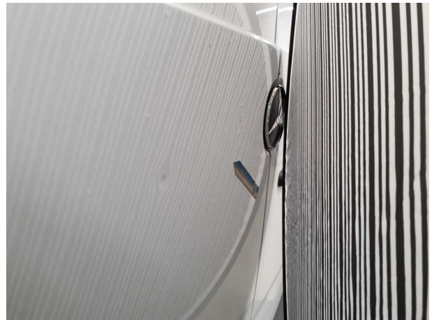
Beschädigung #12: Heckklappe/-tür: Hecktür links - Delle(n) - Smart Repair
