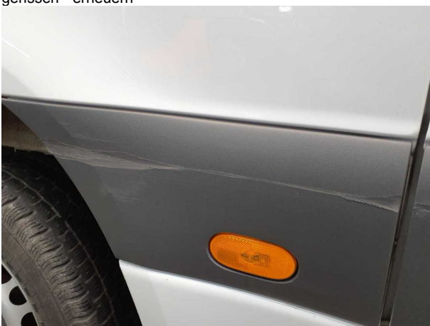
Beschädigung #8: Seitenwand rechts: Schutzleiste (Mitte + hinten) - Abrieb - erneuern
