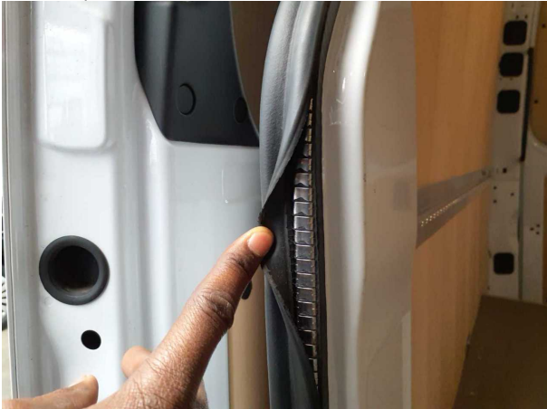
Beschädigung #7: Schiebetür rechts: Türdichtung - gebrochen / gerissen - erneuern
