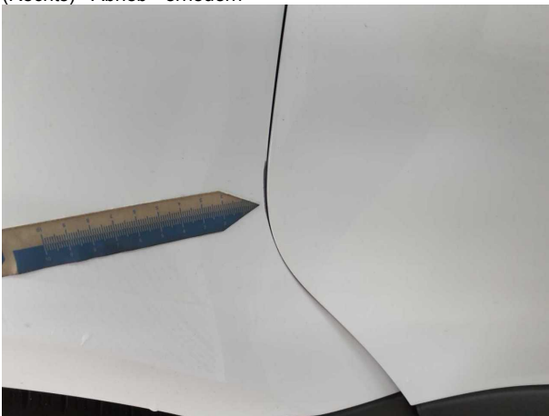
Beschädigung #2: Tür vorn links: Tür - Fehlstellung - einstellen/justieren
