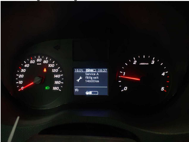
Beschädigung #18: Sonstiges: Inspektion/Wartung - fehlt - erneuern
