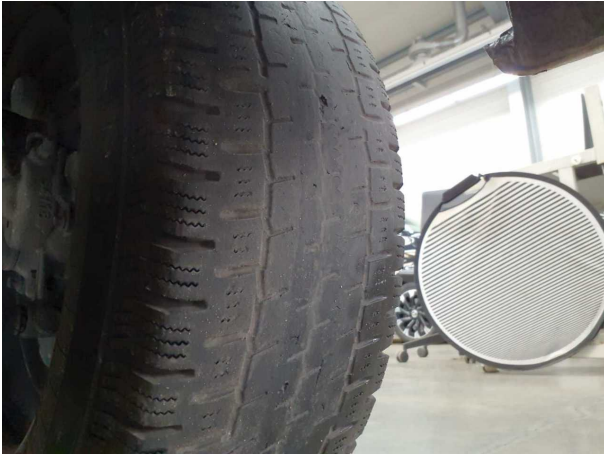
Beschädigung #16: Rad/Reifen: Reifen hinten - verschlissen - erneuern
