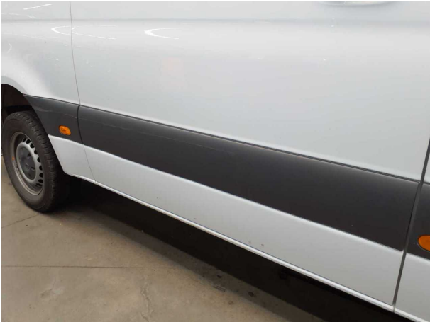
Beschädigung #14: Schiebetür rechts: Zierleiste - Abrieb - erneuern
