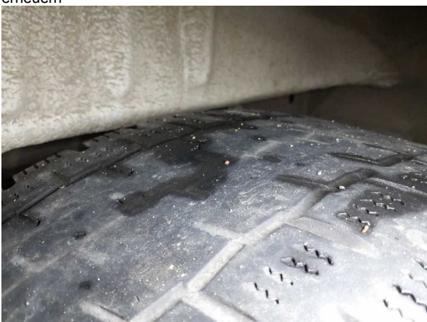
Beschädigung #16: Rad/Reifen: Reifen hinten - verschlissen - erneuern
