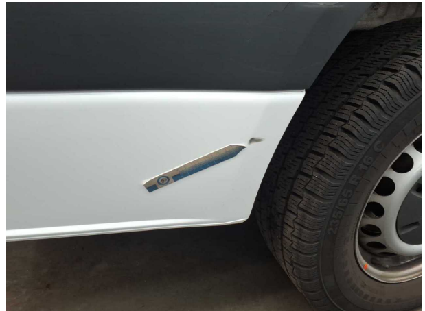
Beschädigung #9: Seitenwand rechts: Seitenwand (Beplankung unten hinten) - Delle / Lackschaden - instandsetzen und lackieren
