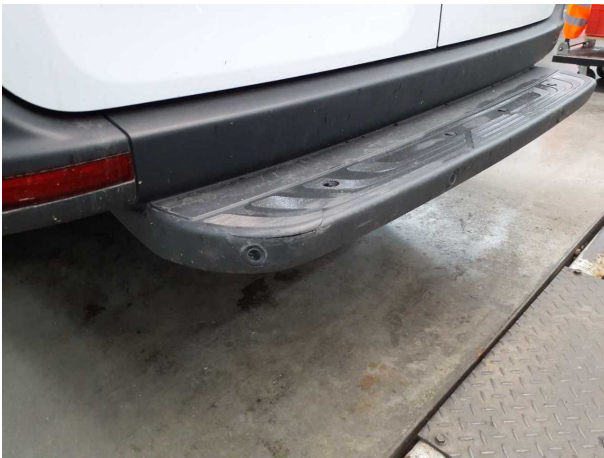
Beschädigung #17: Stossfänger hinten: Verkl. Stossfänger Auftritt mit Parktronic - gebrochen / gerissen - erneuern
