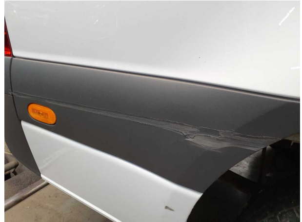
Beschädigung #8: Seitenwand rechts: Schutzleiste (Mitte + hint... - Abrieb - erneuern
