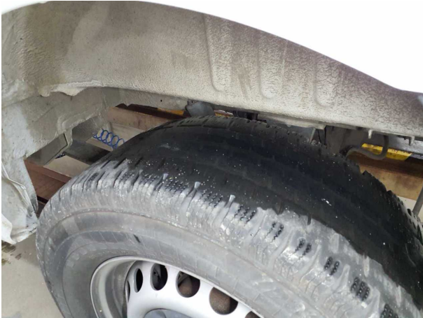
Beschädigung #16: Rad/Reifen: Reifen hinten - verschlissen - erneuern
