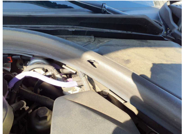
Beschädigung #1: Verglasung: Frontscheibendichtung (Wasserkasten) - beschädigt - erneuern
