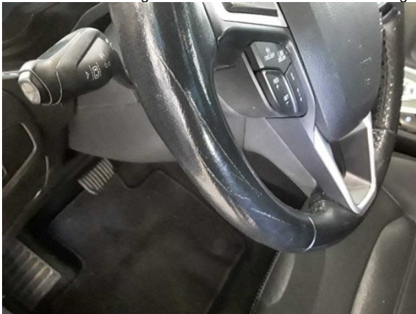
Beschädigung #5: Lenkanlage: Lenkrad - verkratzt / verschürft - Wertminderung
