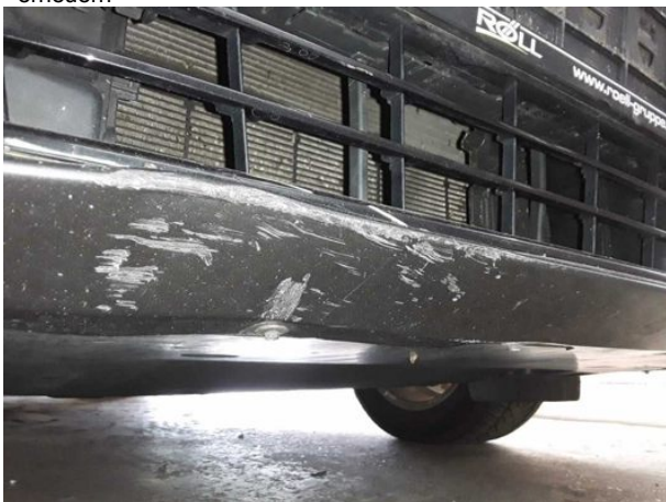
Beschädigung #23: Stossfänger vorn: Stossfänger vorn - verformt - erneuern
