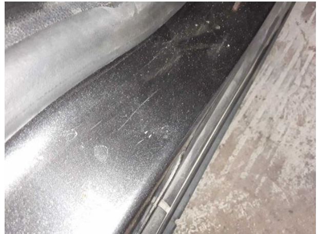
Beschädigung #15: Seitenwand rechts: Einstieg - Delle / Lackschaden - instandsetzen und lackieren
