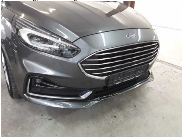
Beschädigung #23: Stossfänger vorn: Stossfänger vorn - verformt - erneuern
