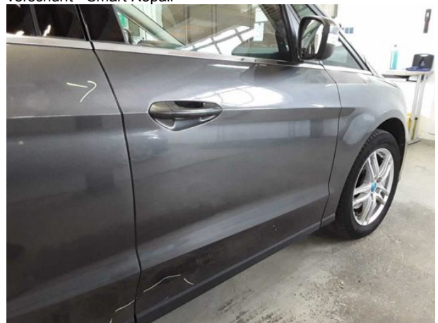
Beschädigung #11: Tür vorn rechts: Tür - verkratzt / verschürft - Smart Repair
