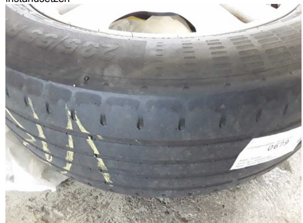
Beschädigung #14: 2.Radsatz: 2 Reifen - verschlissen - erneuern
