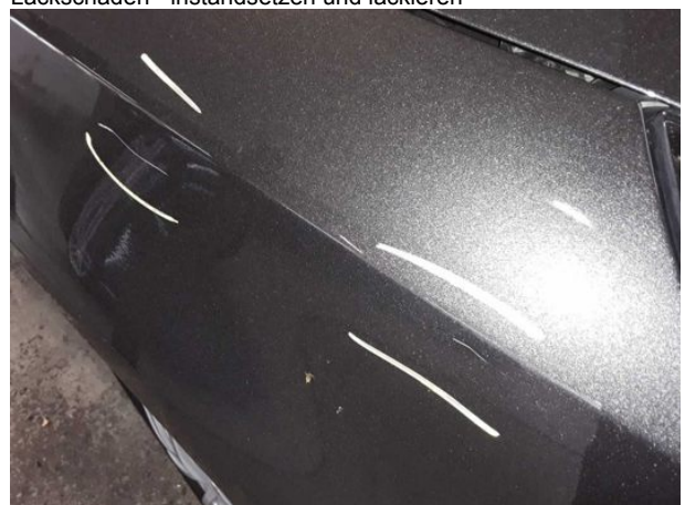
Beschädigung #16: Kotflügel rechts: Kotflügel rechts - verkratzt / verschürft - instandsetzen und lackieren
