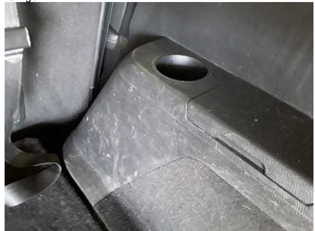
Beschädigung #4: Verkleidungen/Abdeckungen: Kofferraumverkleidung - verkratzt / verschürft - Wertminderung
