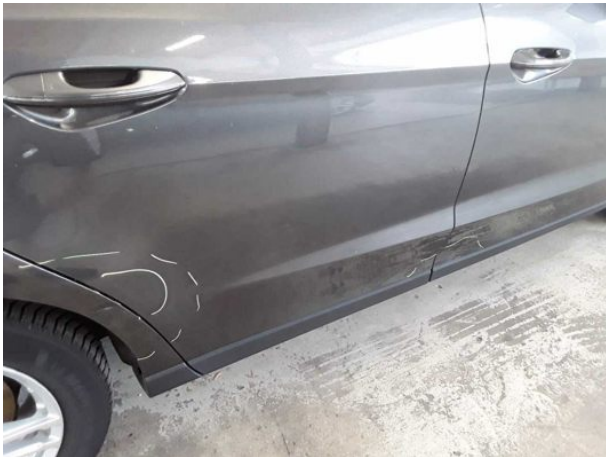
Beschädigung #19: Tür hinten rechts: Tür - Delle / Lackschaden - instandsetzen und lackieren
