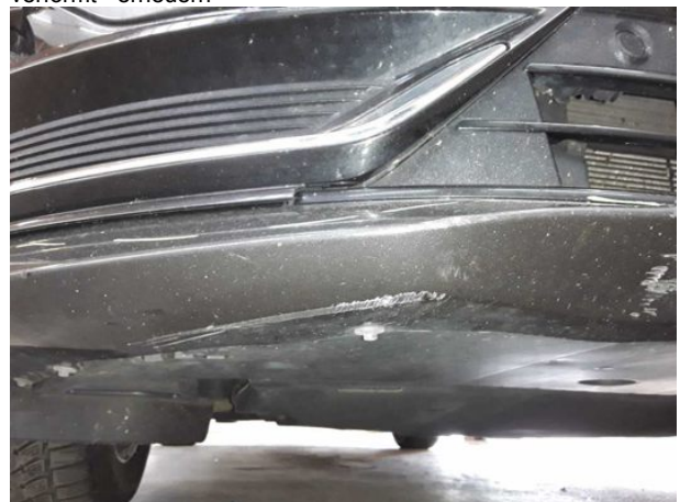
Beschädigung #23: Stossfänger vorn: Stossfänger vorn - verformt - erneuern
