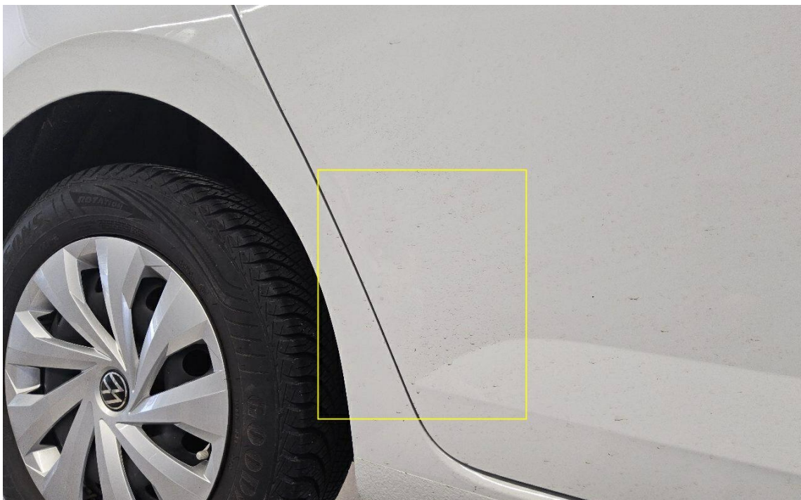
Bild 16 : Tür hinten links eingedellt
