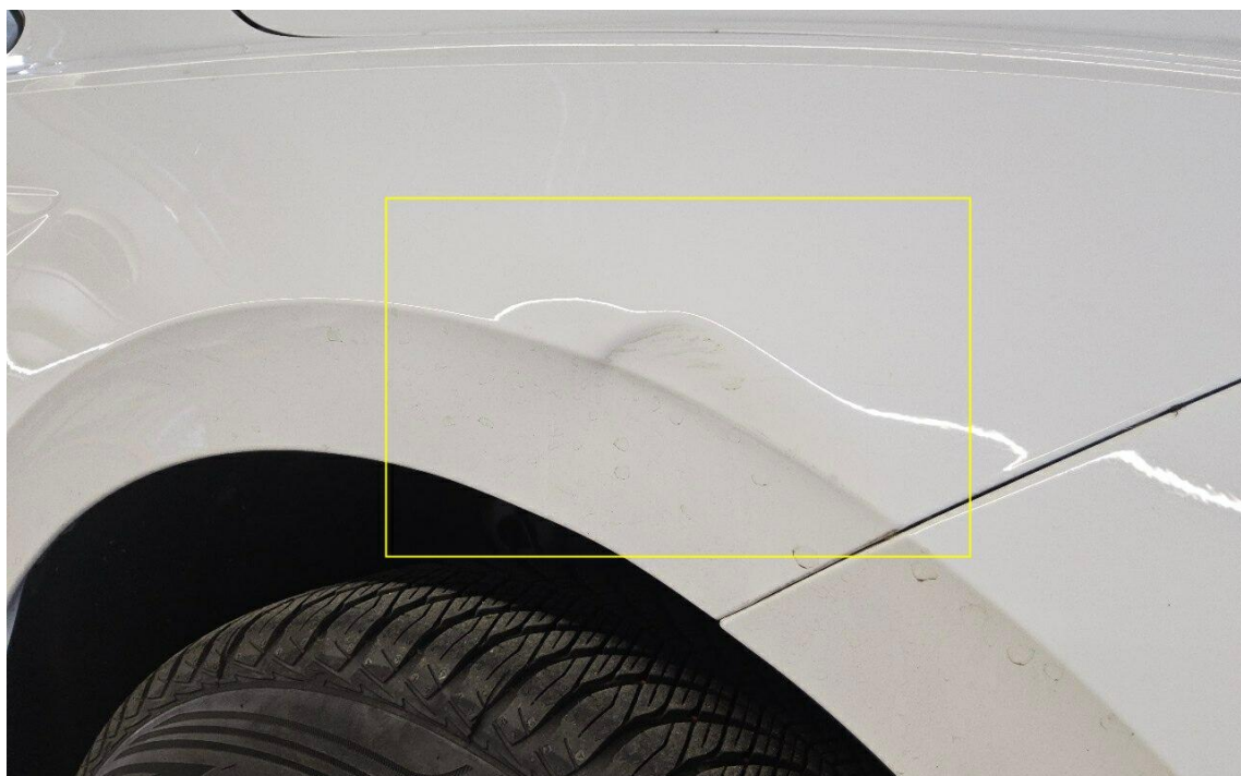
Bild 14 : Kotflügel vorne rechts deformiert
