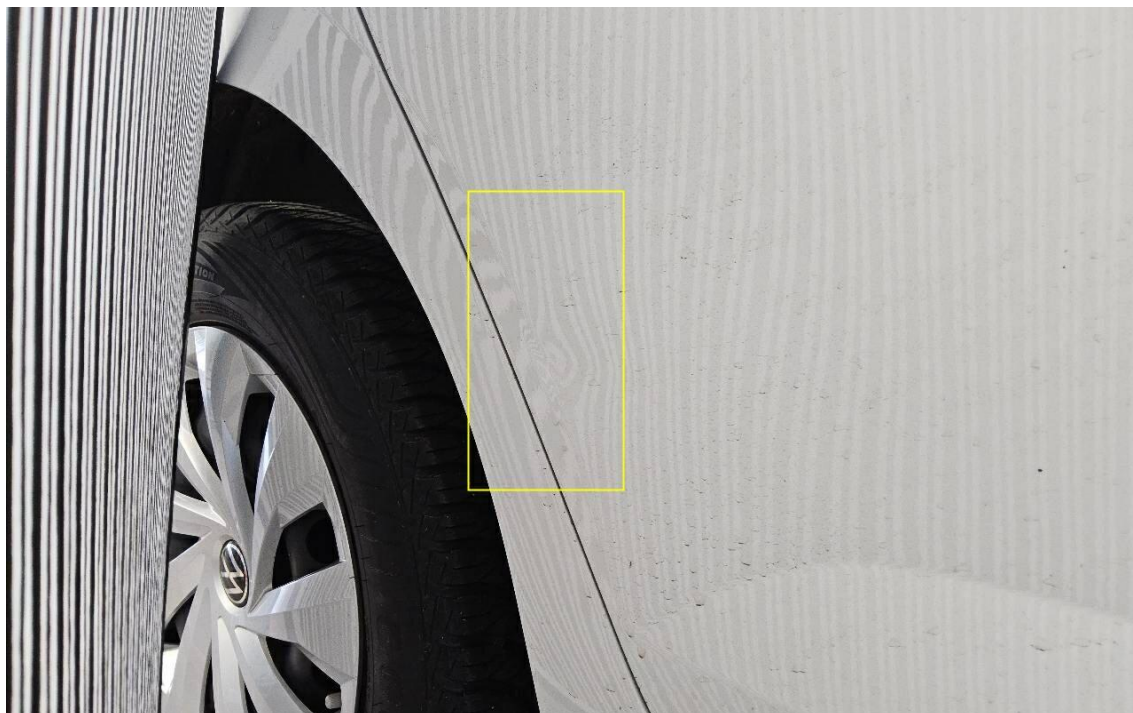
Bild 17 : Tür hinten links eingedellt
