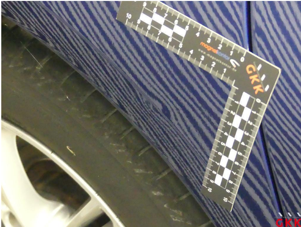
Bild 17 Seitenwand rechts, beschädigt, instand setzen - lackieren
