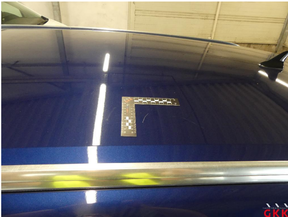
Bild 22 Dach, verkratzt, lackieren
