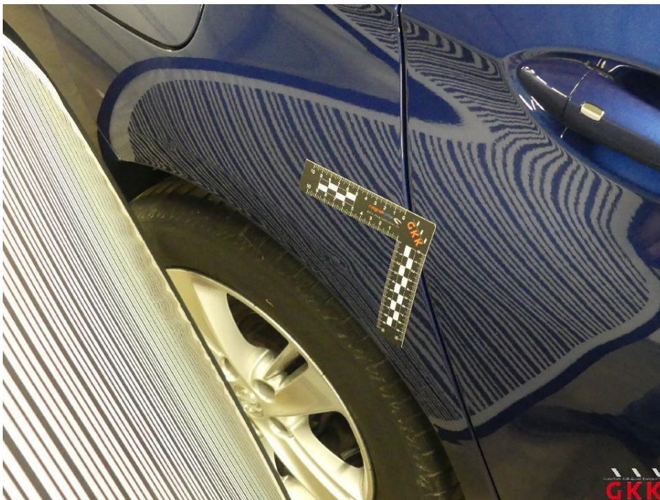
Bild 16 Seitenwand rechts, beschädigt, instand setzen - lackieren
