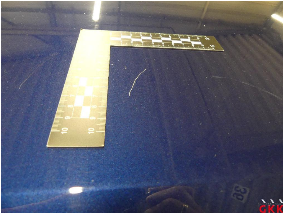
Bild 23 Dach, verkratzt, lackieren
