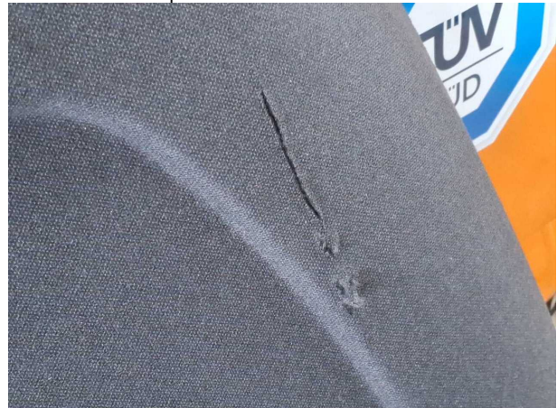
Beschädigung #3: Interieur: Hutablage - gebrochen / gerissen - erneuern
