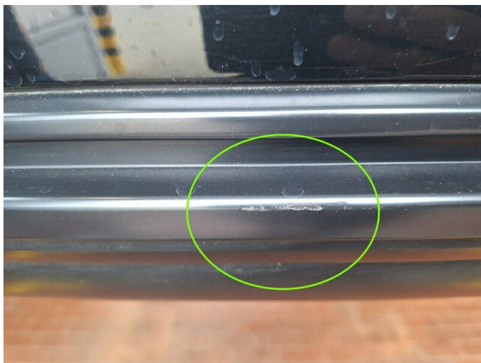
Bild 18 : Spoiler Stoßfänger hinten zerkratzt
