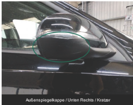
Außenspiegelkappe / Rechts / Kratzer
