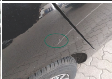
Seitenwand / Unten Rechts / Kratzer
