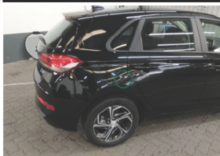
Seitenwand / Unten Rechts / Kratzer
