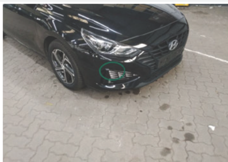
Abdeckung / Vorne Rechts / Kratzer
