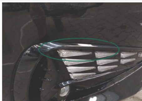
Abdeckung / Vorne Rechts / Kratzer
