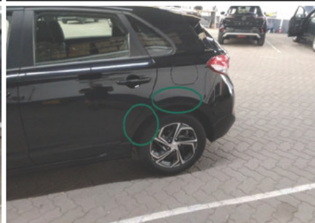
Seitenwand / Unten Links / Delle
