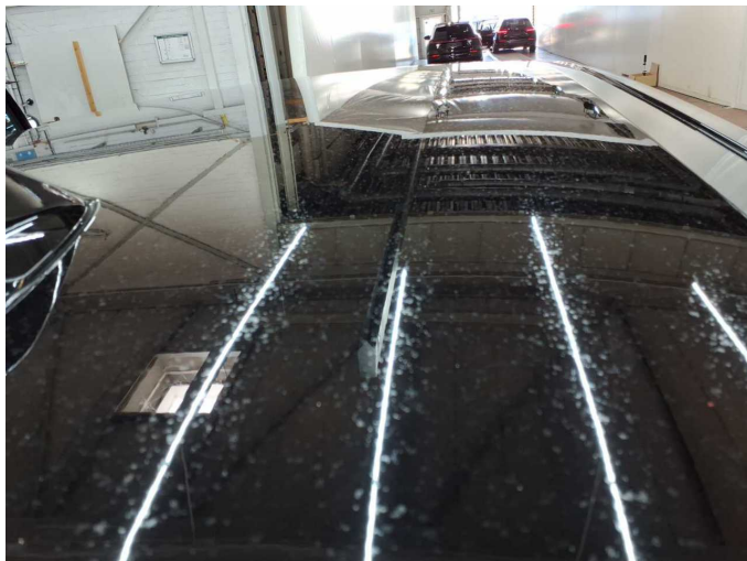
Damage 7: Roof: Roof (Anhaftung verätzung hartz) - Paint defect - Paint
