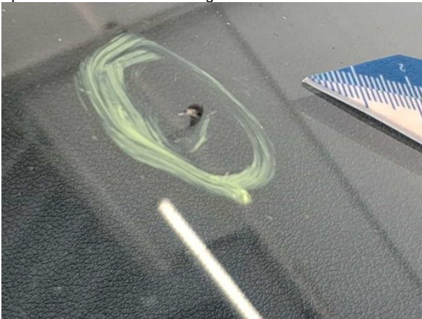
Beschädigung #5: Verglasung: Frontscheibe mit Spurhalteassistent - Steinschlag - erneuern
