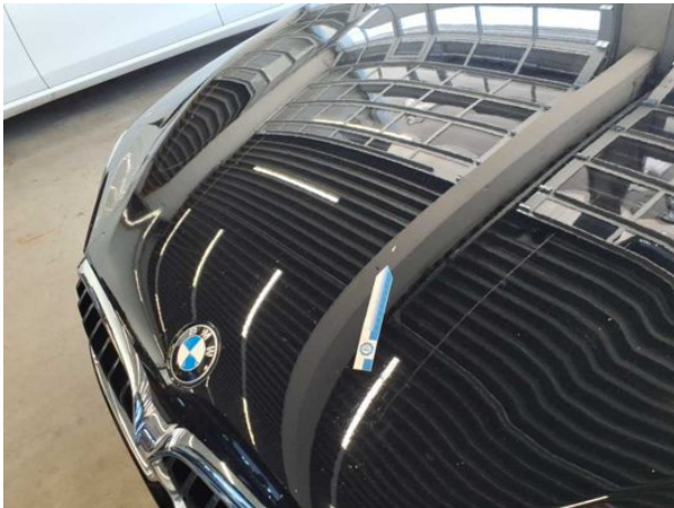
Beschädigung #4: Motorhaube: Motorhaube - Delle / Lackschad... - instandsetzen und lackieren
