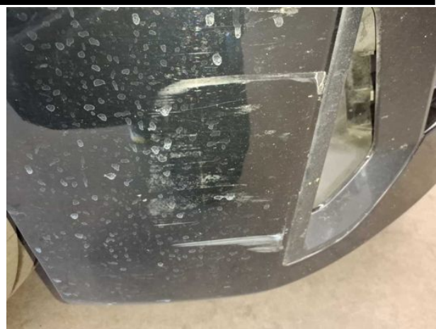
Beschädigung #3: Stossfänger vorn: Stossfänger vorn - Kratzer - instandsetzen und lackieren
