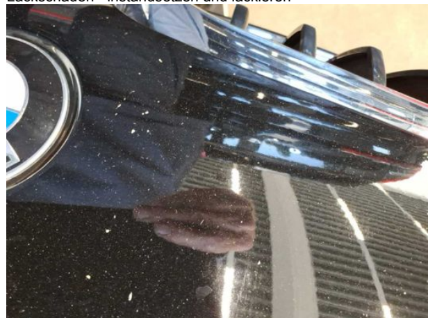
Beschädigung #4: Motorhaube: Motorhaube - Delle / Lackschaden - instandsetzen und lackieren
