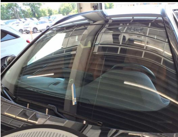
Beschädigung #5: Verglasung: Frontscheibe mit Spurhalteassistent - Steinschlag - erneuern
