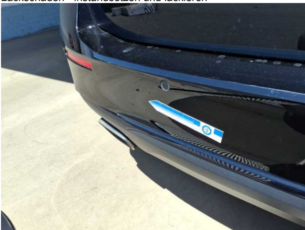
Beschädigung #2: Stossfänger hinten: Stossfänger hinten - Delle / Lackschaden - instandsetzen und lackieren
