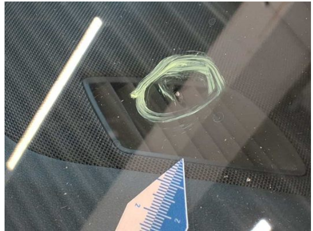
Beschädigung #5: Verglasung: Frontscheibe mit Spurhalteassistent - Steinschlag - erneuern
