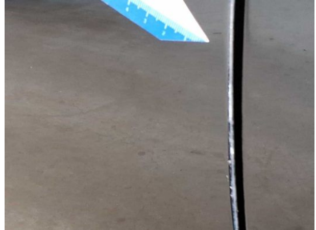
Beschädigung #1: Tür vorn links: Türkante - Kratzer - auslegen / polieren
