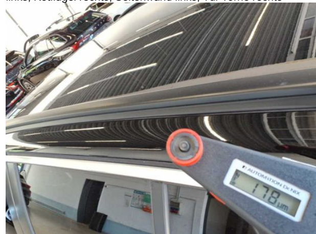
Nachlackierung 1: Dachholm links, Dachholm rechts, Kotflügel links, Kotflügel rechts, Seitenwand links, Tür vorne rechts
