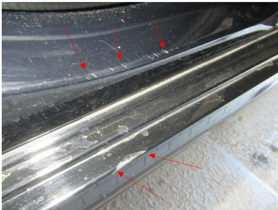
Bild 14 : Einstieg hinten rechts zerkratzt
