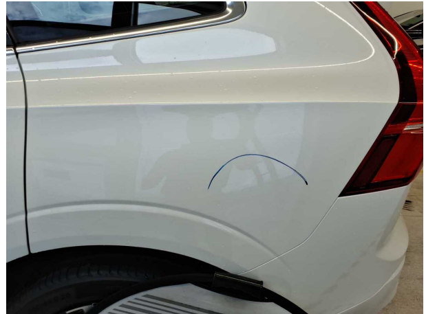
Beschädigung #5: Seitenwand links: Seitenwand - Kratzer - lackieren
