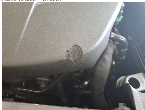
Beschädigung #3: Motor: Motorabdeckung - Marderschaden - erneuern
