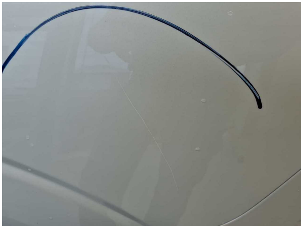
Beschädigung #5: Seitenwand links: Seitenwand - Kratzer - lackieren
