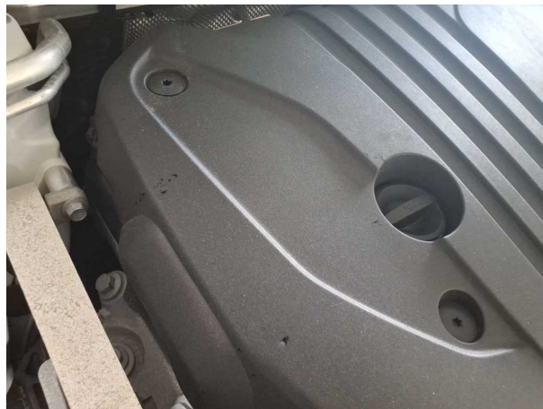
Beschädigung #3: Motor: Motorabdeckung - Marderschaden - erneuern
