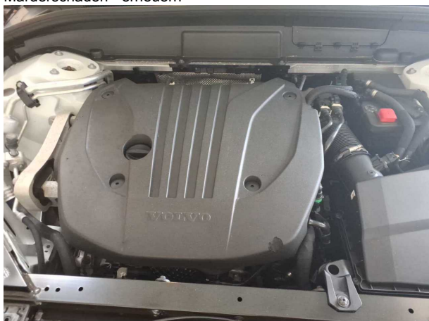
Beschädigung #3: Motor: Motorabdeckung - Marderschaden - erneuern
