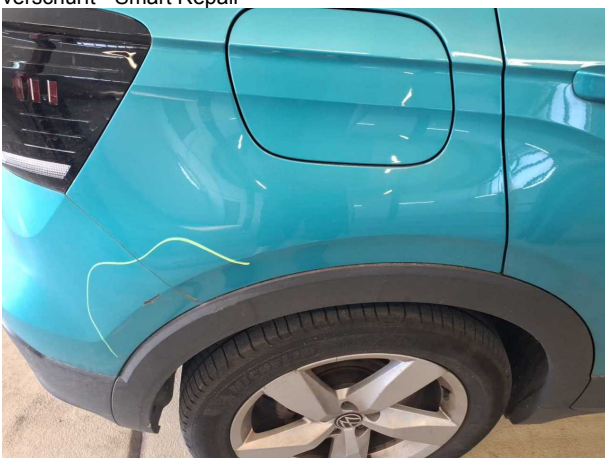
Beschädigung #6: Seitenwand rechts: Seitenwand - verkratzt / verschürft - Smart Repair
