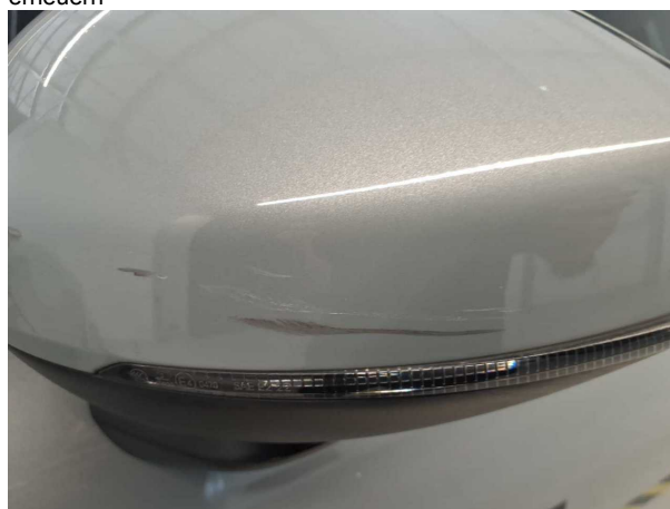
Beschädigung #5: Außenspiegel links: Abdeckkappe - Kratzer - Smart Repair
