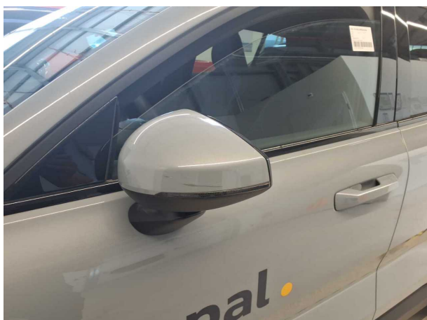
Beschädigung #5: Außenspiegel links: Abdeckkappe - Kratzer - Smart Repair
