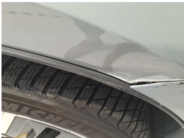
Beschädigung #4: Kotflügel rechts: Radlauf - beschädigt - erneuern
