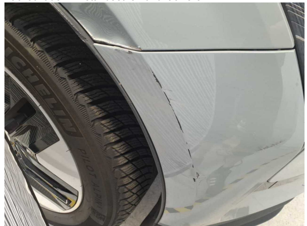
Beschädigung #9: Stossfänger vorn: Stossfänger vorn - Delle / Lackschaden - instandsetzen und lackieren
