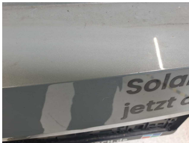
Beschädigung #2: Stossfänger hinten: Stossfänger hinten - Kratzer - auslegen / polieren
