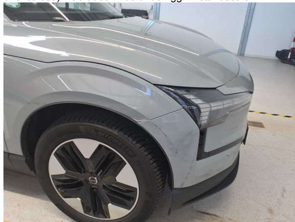
Beschädigung #4: Kotflügel rechts: Radlauf - beschädigt - erneuern
