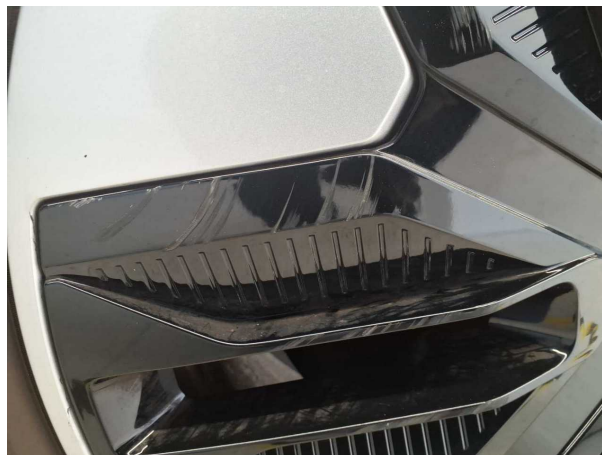
Beschädigung #1: Rad/Reifen: Raddeckel (Radkappe innen hint... links) - beschädigt - erneuern
