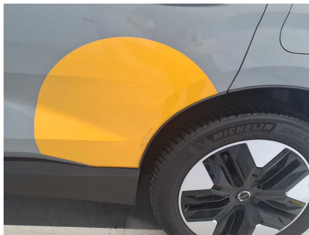
Beschädigung #10: Tür hinten links: Tür - Delle / Lackschaden - instandsetzen und lackieren
