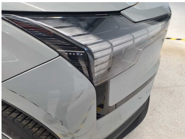
Beschädigung #12: Scheinwerfer: Scheinwerfer rechts - Kratzer - erneuern
