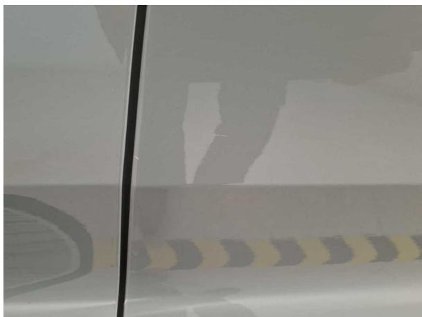
Beschädigung #10: Tür hinten links: Tür - Delle / Lackschaden - instandsetzen und lackieren
