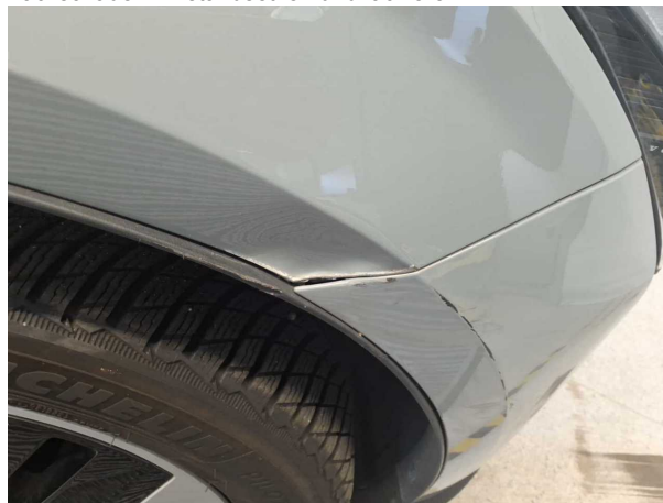
Beschädigung #11: Kotflügel rechts: Kotflügel rechts - Delle / Lackschaden - instandsetzen und lackieren
