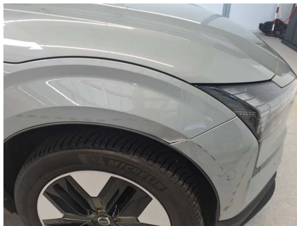
Beschädigung #11: Kotflügel rechts: Kotflügel rechts - Delle / Lackschaden - instandsetzen und lackieren
