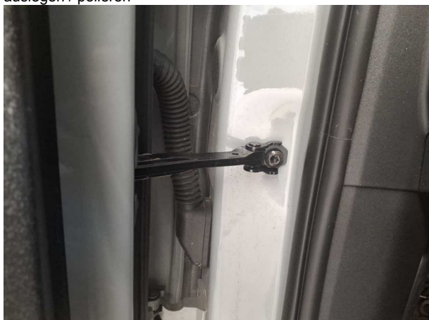
Beschädigung #3: Tür vorn links: Fangband / Feststeller (Knackt und ist lose) - Geräusch - befunden ggf. instandsetzen
