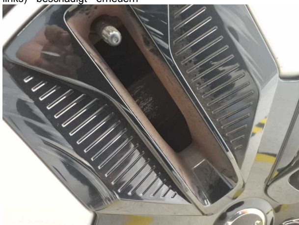
Beschädigung #1: Rad/Reifen: Raddeckel (Radkappe innen hinten links) - beschädigt - erneuern
