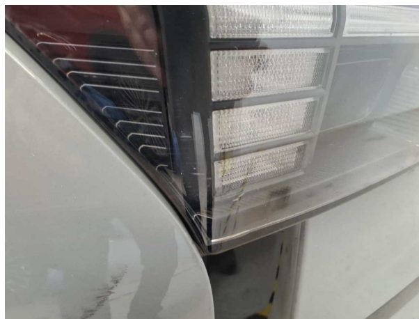
Beschädigung #12: Scheinwerfer: Scheinwerfer rechts - Kratzer - erneuern
