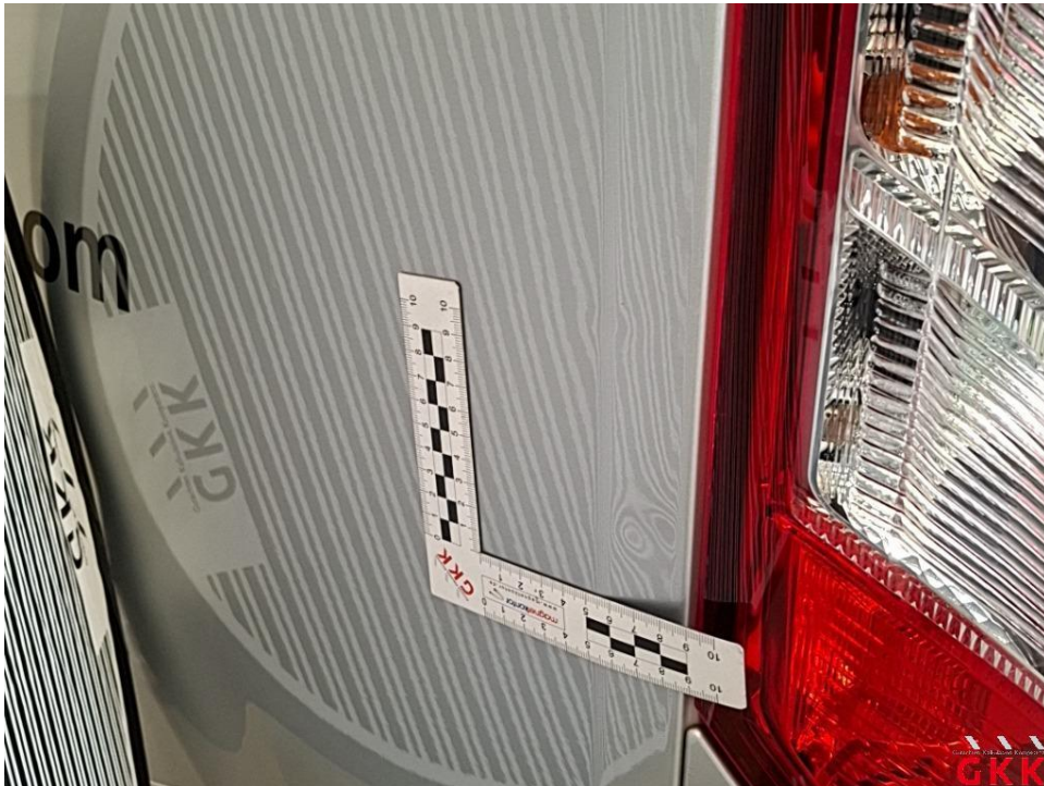
Bild 19 Seitenwand links, beschädigt, kalt drücken
