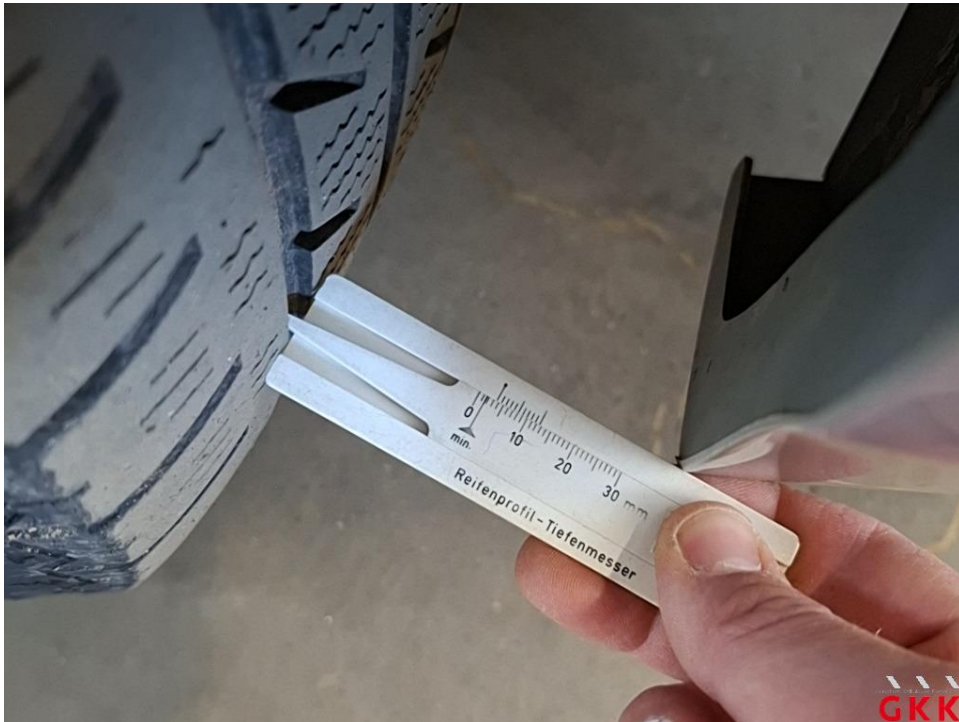
Bild 17 Reifen, vorn links und rechts, Untermaß, ersetzen
