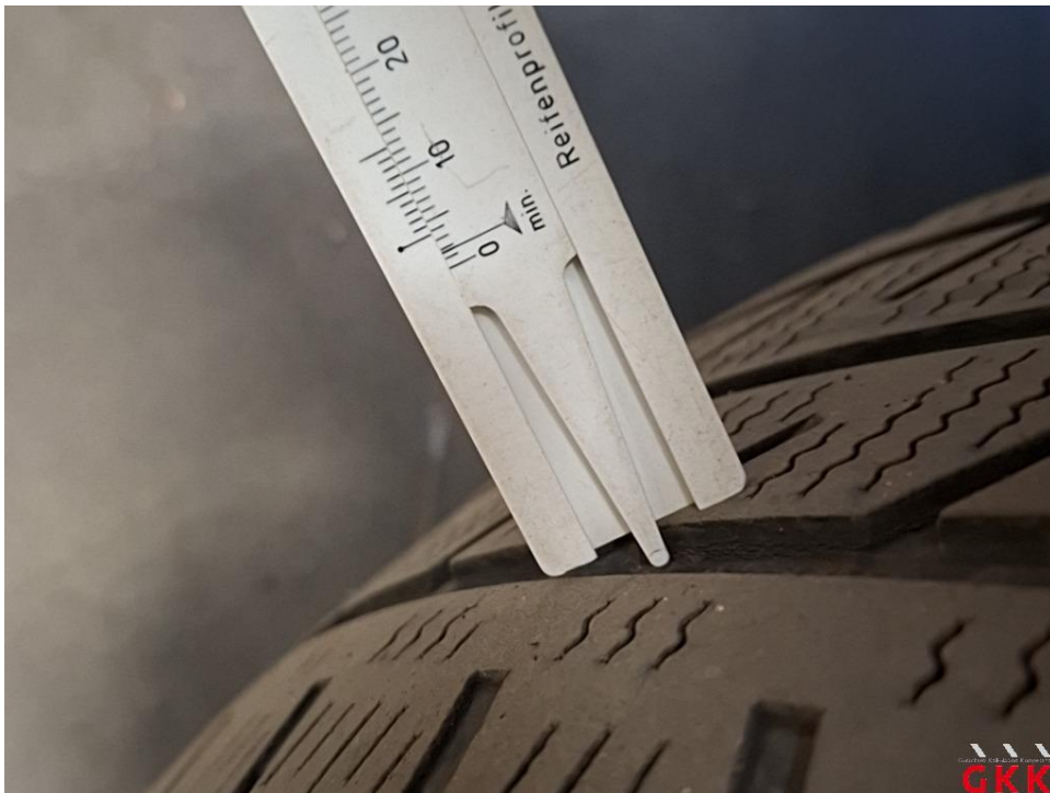
Bild 16 Reifen, vorn links und rechts, Untermaß, ersetzen
