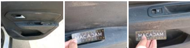
Door panel RR, Scratch(es), Replace
