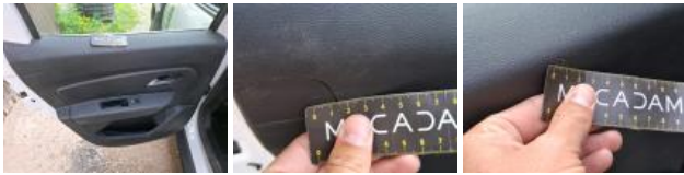
Door panel RR, Scratch(es), Replace
