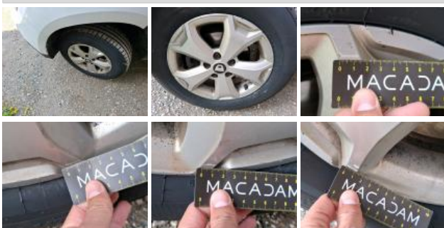
Alloy rim FR, Scratch(es), Repair/replace (lump sum)
