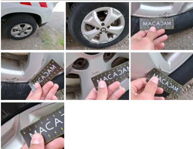
Alloy rim FL, Scratch(es), Repair/replace (lump sum)
