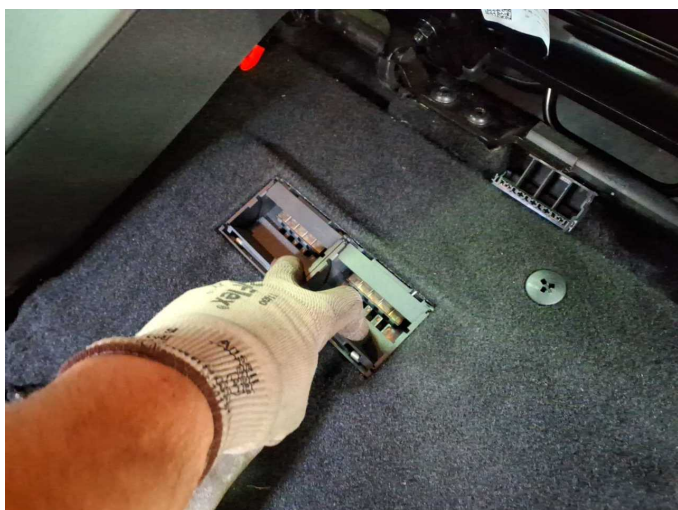
Damage 5: Misc.: Misc. (Stecker Sitzheizung, Mehrkosten möglich) - Broken / torn - Replace
