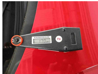
Lackstärke Kotflügel vorne rechts
