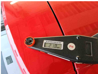
Lackstärke Seitenwand hinten rechts
