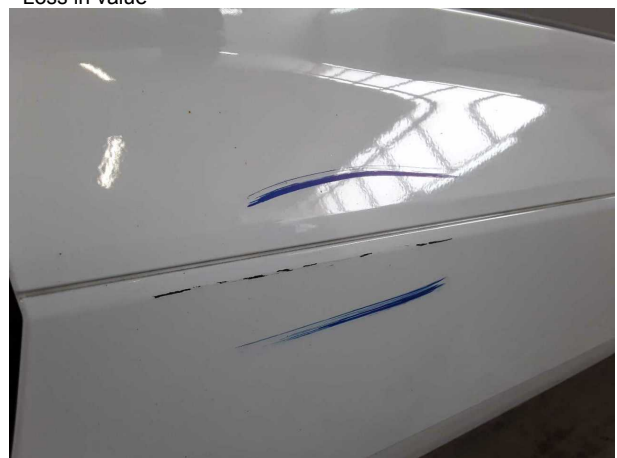
Damage #3: Door - front right side: Door (Leiste Abdeckung) - Scratched - Smart repair
