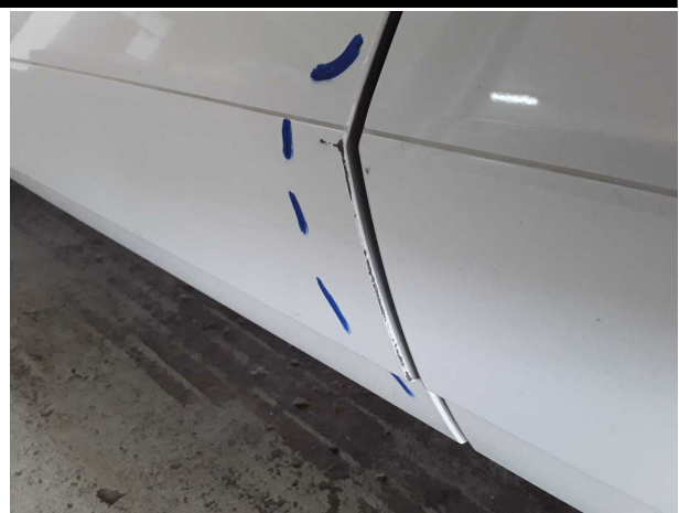
Damage #5: Door - front left side: Door (Leiste Abdeckung) - Scratched - Smart repair
