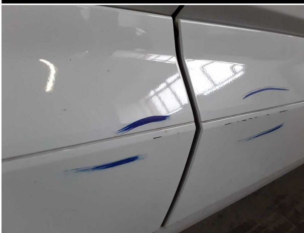
Damage #4: Door - rear right side: Door (Leiste Abdeckung) - Scratched - Smart repair
