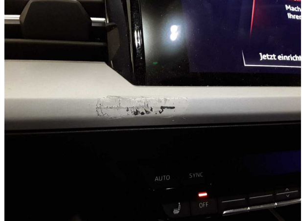
Beschädigung #6: Instrumententafel: Mittelkonsole vorn - verkratzt / verschürft - Wertminderung
