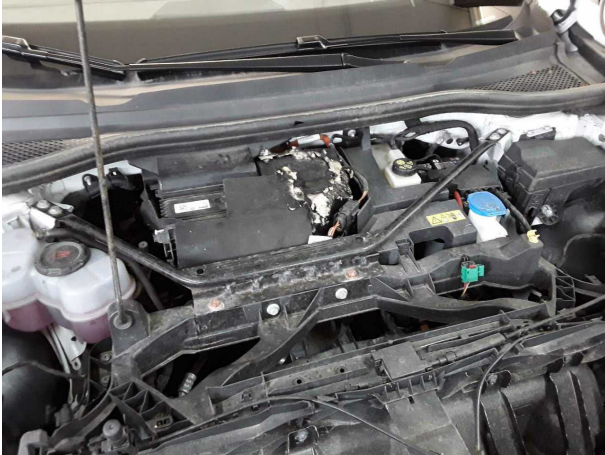
Beschädigung #1: Motor: Motorabdeckung oben / Blende - Marderschaden - erneuern
