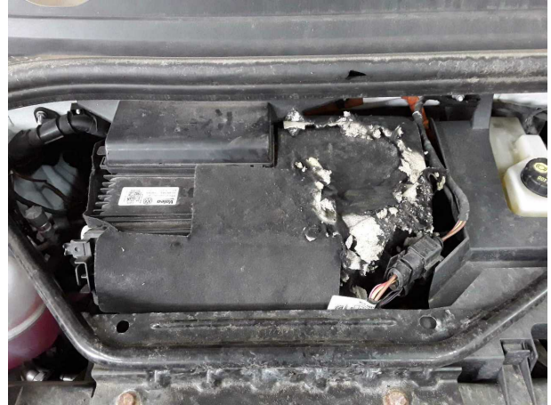
Beschädigung #1: Motor: Motorabdeckung oben / Blende - Marderschaden - erneuern
