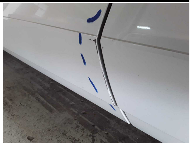
Beschädigung #5: Tür vorn links: Tür (Leiste Abdeckung) - verkratzt / verschürft - Smart Repair
