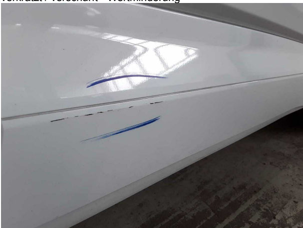
Beschädigung #3: Tür vorn rechts: Tür (Leiste Abdeckung) - verkratzt / verschürft - Smart Repair
