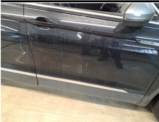
Beschädigung #18: Tür vorn rechts: Tür - Delle / Lackschaden - instandsetzen und lackieren
