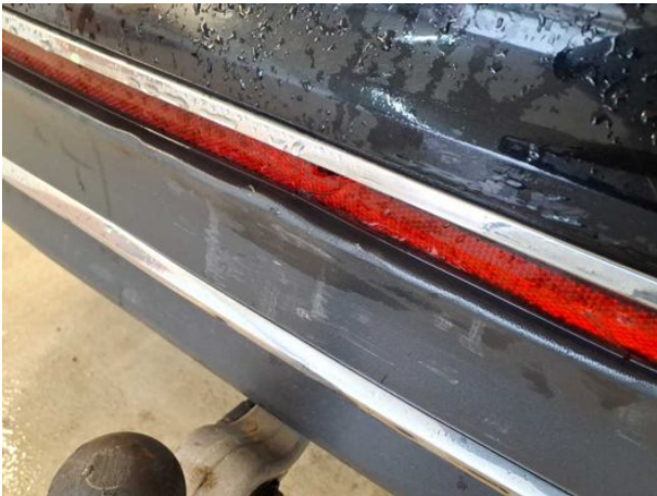
Beschädigung #15: Stossfänger hinten: Spoiler - verformt - erneuern
