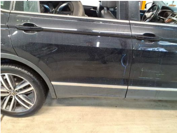
Beschädigung #12: Tür hinten rechts: Tür - Delle(n) - sanft instandsetzen
