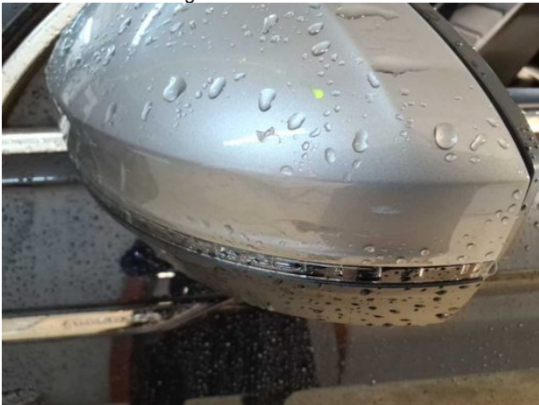
Beschädigung #3: Außenspiegel links: Abdeckkappe - Abrieb - auslegen / polieren
