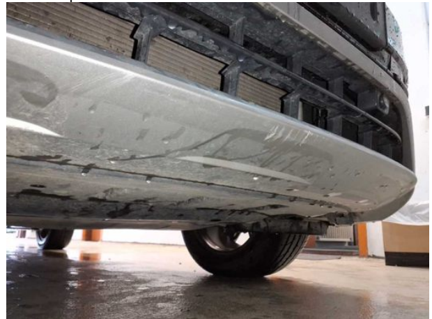
Beschädigung #9: Stossfänger vorn: Spoiler - verkratzt / verschürft - Wertminderung
