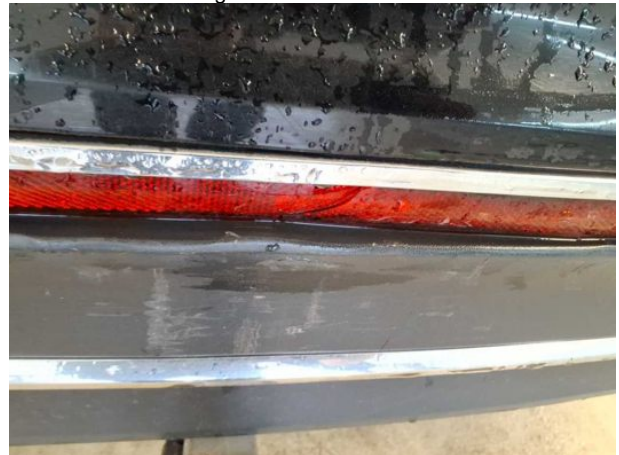
Beschädigung #5: Heckklappe/-tür: Reflektoren - beschädigt - erneuern
