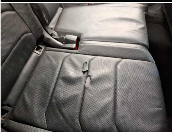
Beschädigung #14: Sitz hinten: Sitzbezug - beschädigt - erneuern
