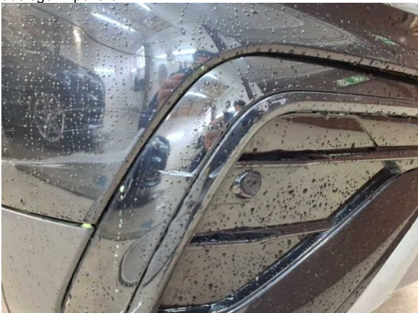
Beschädigung #6: Stossfänger vorn: Lufteinlassgitter - beschädigt - erneuern
