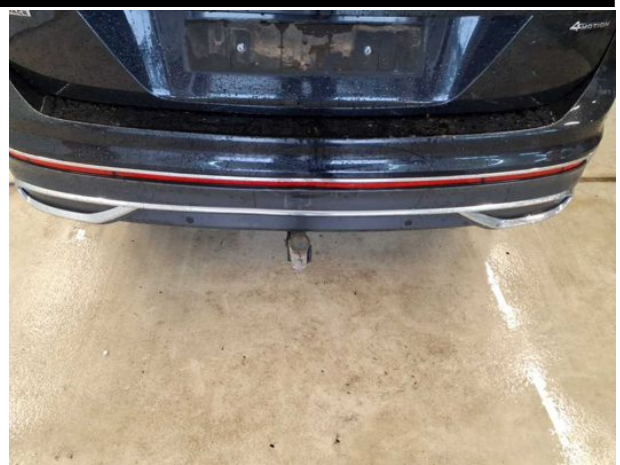
Beschädigung #15: Stossfänger hinten: Spoiler - verformt - erneuern
