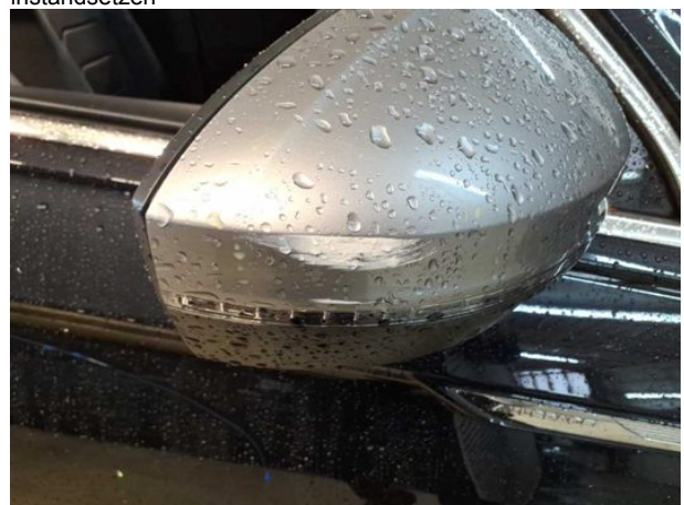
Beschädigung #13: Außenspiegel rechts: Abdeckkappe - verkratzt / verschürft - erneuern
