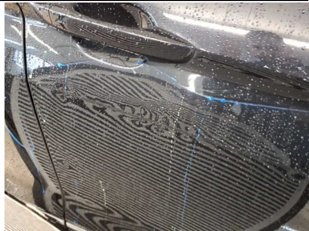
Beschädigung #18: Tür vorn rechts: Tür - Delle / Lackschaden - instandsetzen und lackieren
