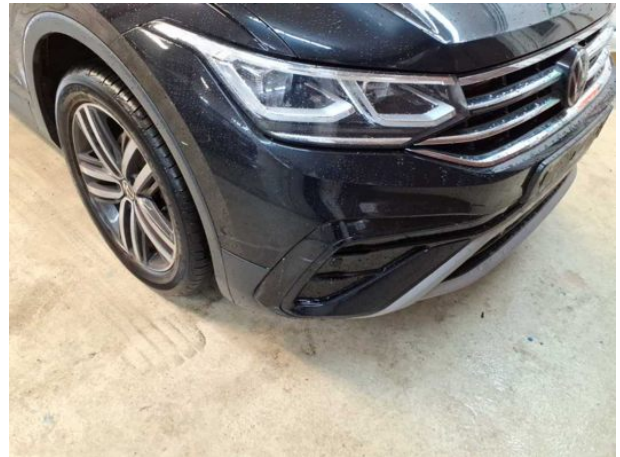
Beschädigung #17: Stossfänger vorn: Stossfänger vorn - verkratzt / verschürft - instandsetzen und lackieren
