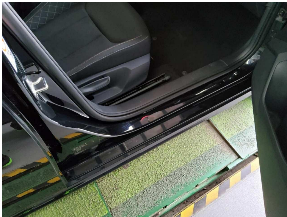
Bild 14 : Tür vorne rechts Einstieg, eingedellt, smart repair
