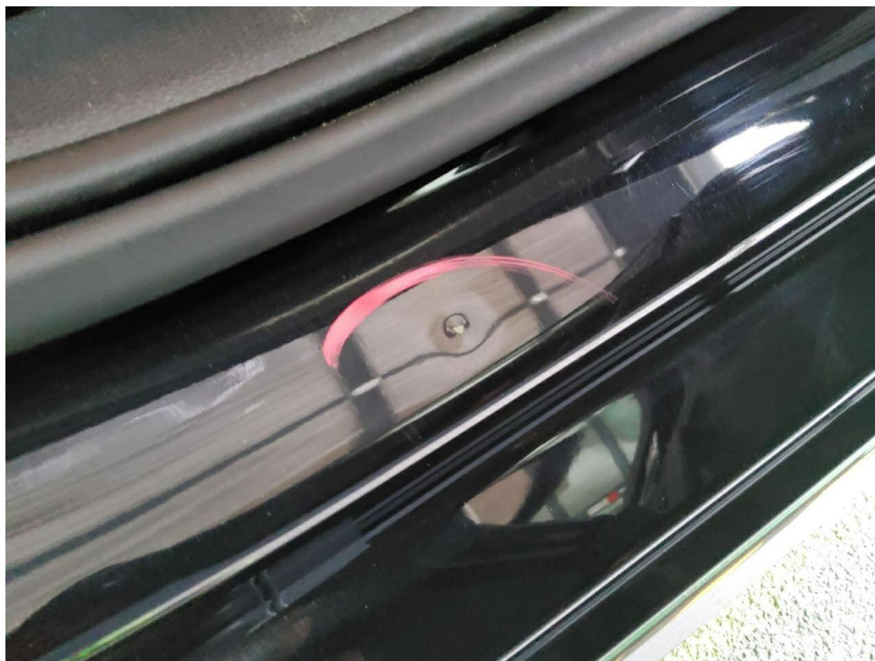
Bild 15 : Tür vorne rechts Einstieg, eingedellt, smart repair
