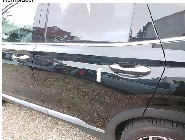
Domage 9: Porte ArG: Porte - Bosse, dommage peinture - Réparer et repeindre
