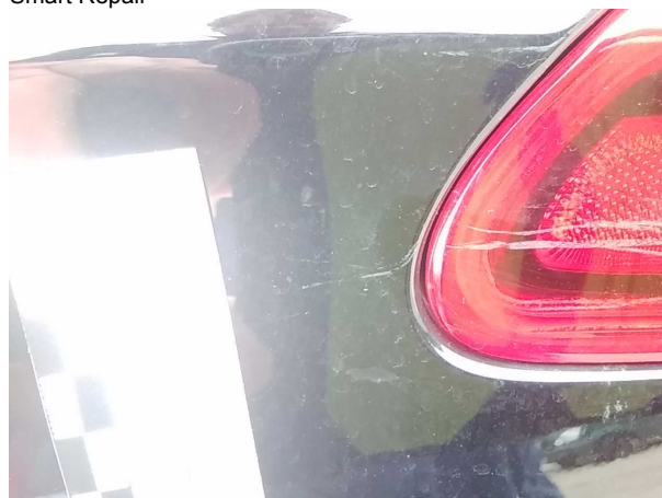
Beschädigung 2: Seitenwand links: Seitenwand - Kratzer - Smart Repair
