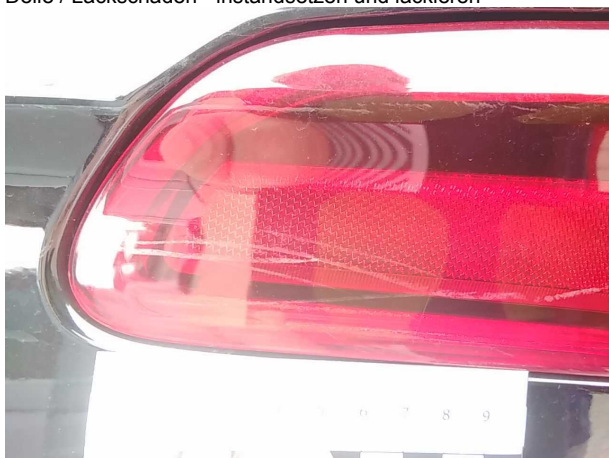
Beschädigung 8: Heckleuchte: Heckleuchte links - Kratzer - erneuern
