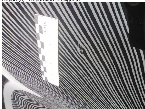
Dommage 3: Porte ArD: Porte - Bosse, dommage peinture - Réparation intelligente
