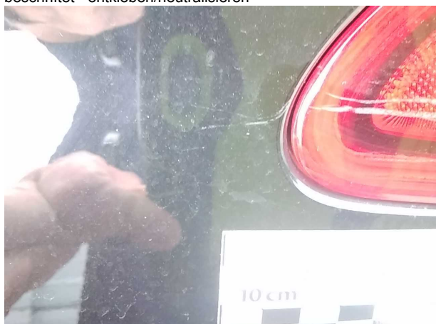
Beschädigung 2: Seitenwand links: Seitenwand - Kratzer - Smart Repair
