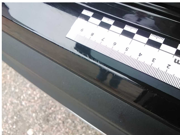
Domage 7: Pare-chocs arrière: Pare-chocs avec Parktronic - Bosse, dommage peinture - Réparer et repeindre
