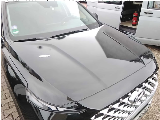
Beschädigung 6: Motorhaube: Motorhaube - nicht fachgerecht instandgesetzt - instandsetzen und lackieren
