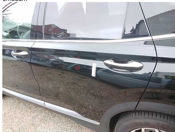
Beschädigung 9: Tür hinten links: Tür - Delle / Lackschaden - instandsetzen und lackieren
