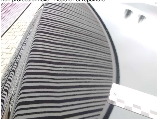
Domage 6: Capot moteur: Capot moteur - Réparé de manière non professionnelle - Réparer et repeindre
