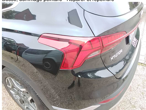
Domage 8: Feu arrière: Feu arrière gauche - Rayure(s) - Remplacer
