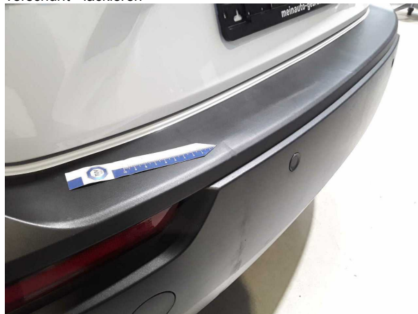
Beschädigung #2: Stossfänger hinten: Stossfänger hinten - verformt - erneuern
