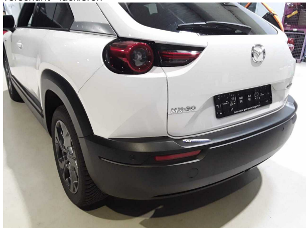
Beschädigung #2: Stossfänger hinten: Stossfänger hinten - verformt - erneuern
