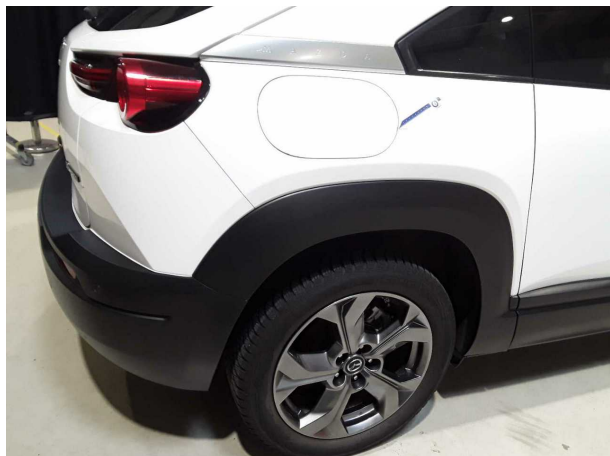
Beschädigung #1: Kraftstoffanlage: Tankklappe - verkratzt / verschürft - lackieren
