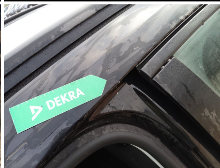
Poste de techo A/ B / C / Delantero Derecho / Abolladura
