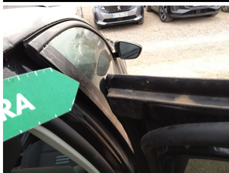
Junta de ventana / Trasero Derecho / Roto
