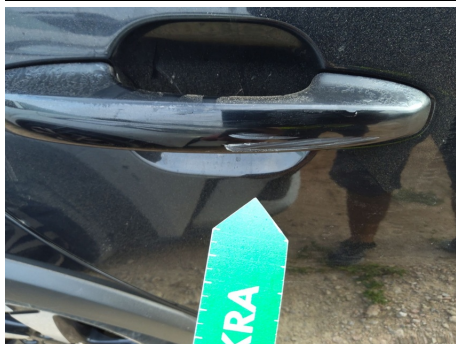
Manetas de puerta / Trasero Derecho / Ralladura
