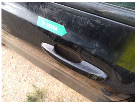
Puerta / Delantero Izquierdo / Abolladura
