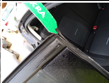
Junta de ventana / Trasero Derecho / Roto
