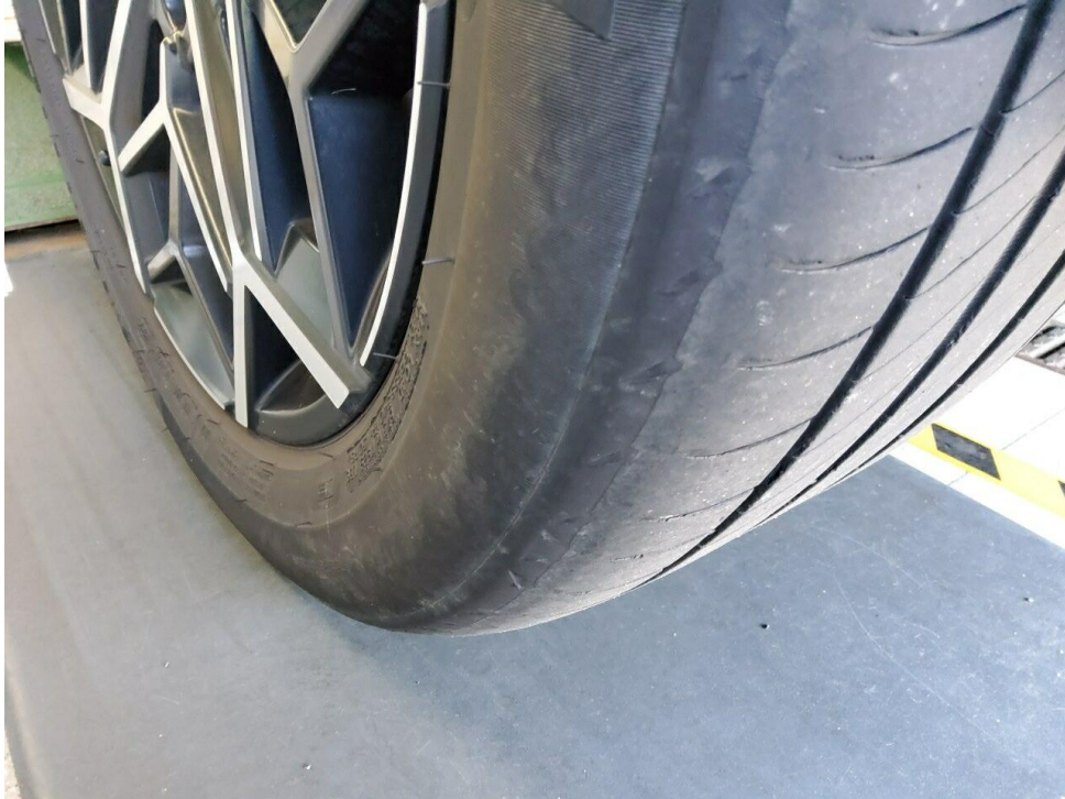
Bild 9 : Reifen hinten links aussen abgelaufen
