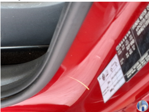
1. Türeinstieg Vorne - Links Beschädigt - Sanft Instandsetzen
