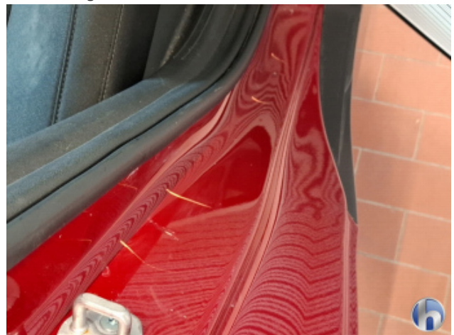
4. Türeinstieg Hinten - Links Beschädigt - Sanft Instandsetzen
