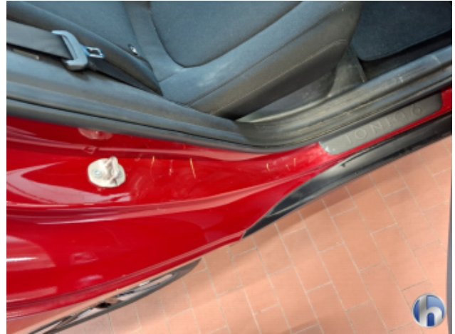
4. Türeinstieg Hinten - Links Beschädigt - Sanft Instandsetzen
