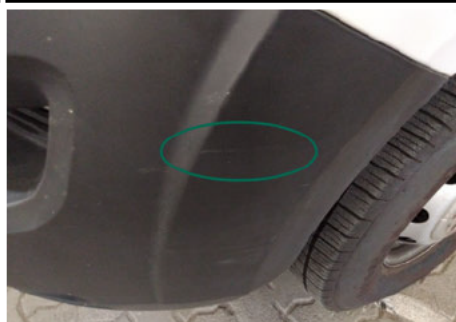
Stoßfänger / Vorne Links / Kratzer
