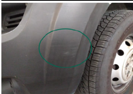
Stoßfänger / Vorne Links / Kratzer
