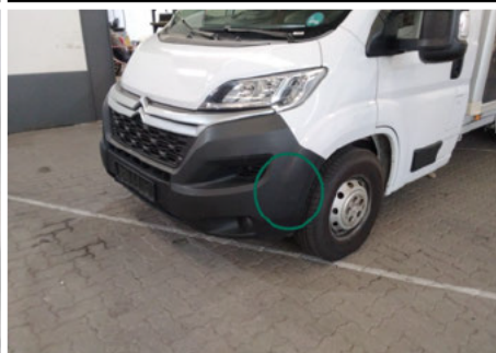
Stoßfänger / Vorne Links / Kratzer
