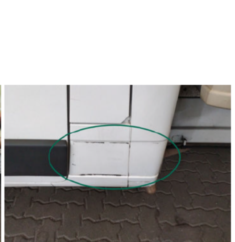
Zerleiste Seitenwand / Hinten Links / Fehlt
