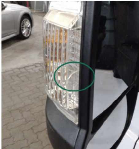
Außenspiegelkappe / Links / Gebrochen
