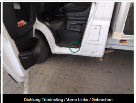
Dichtung Türeinstieg / Vorne Links / Gebrochen
