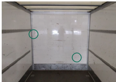
Seitenwand / Vorne / Gebrochen
