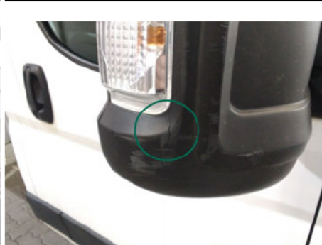
Außenspiegelkappe / Rechts / Gebrochen
