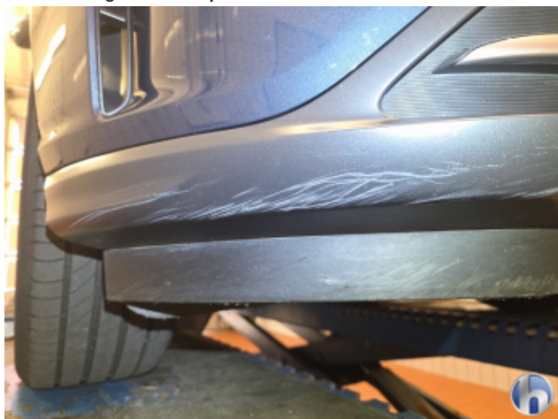
1. Frontspoiler Abschürfung - Smart Repair
