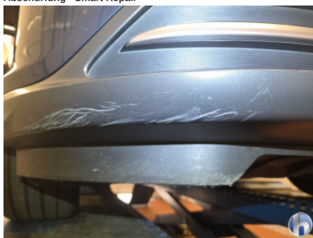
1. Frontspoiler Abschürfung - Smart Repair
