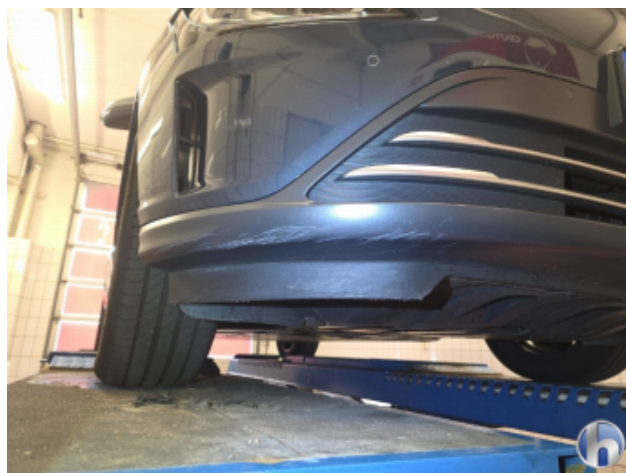
1. Frontspoiler Abschürfung - Smart Repair
