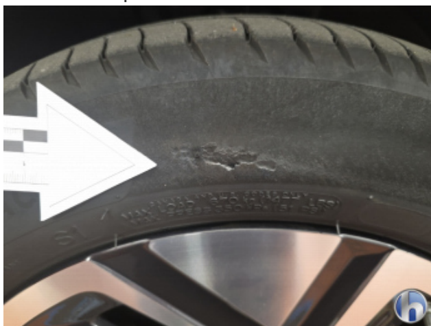
3. Reifen Vorne - Links Nicht Verkehrssicher - Erneuern
