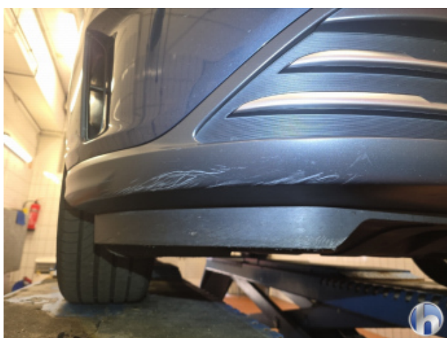
1. Frontspoiler Abschürfung - Smart Repair
