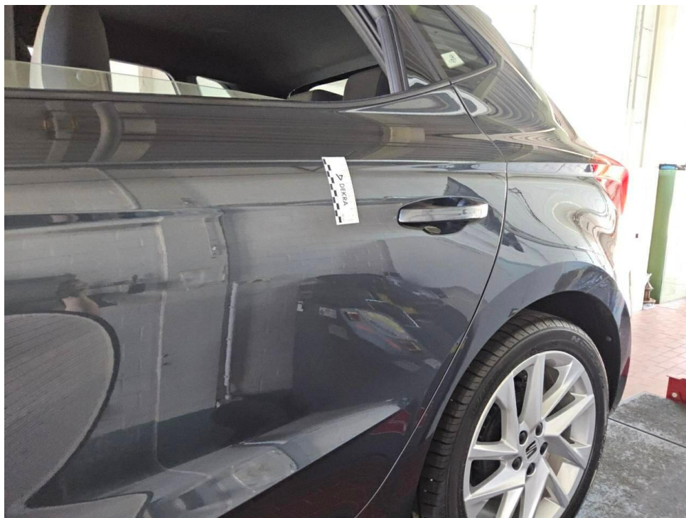
Bild 17 : Tür hinten links, eingedellt, drücken
