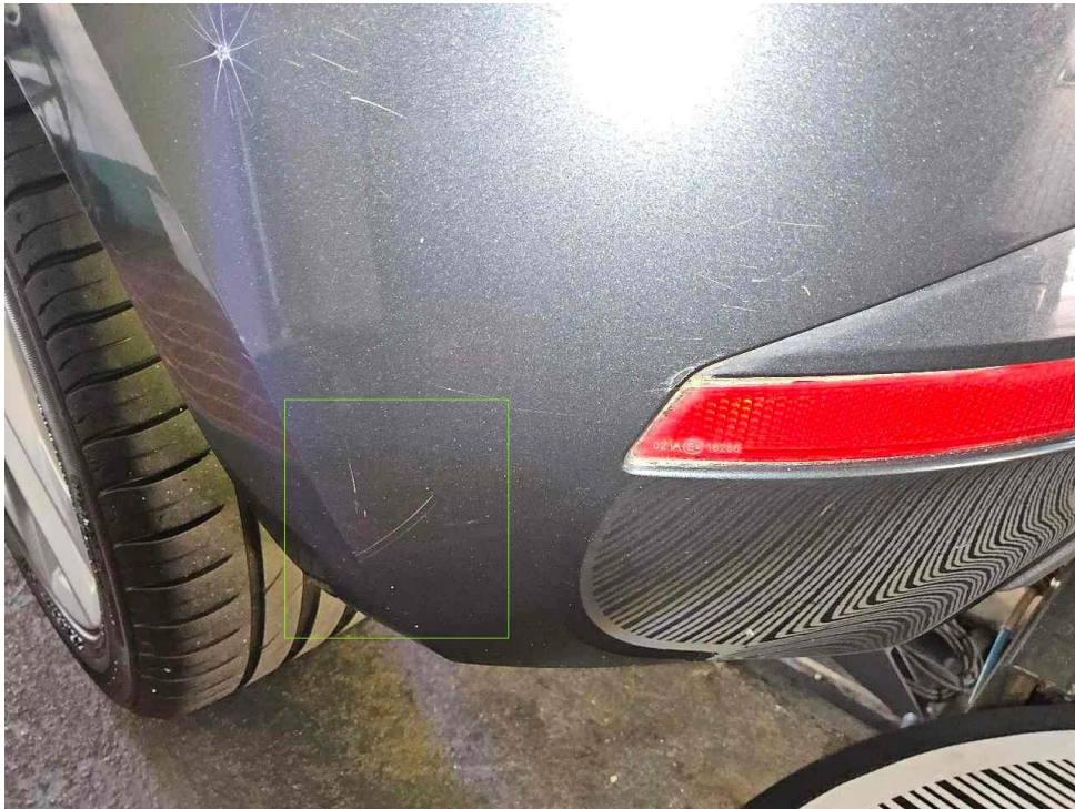
Bild 33 : Stoßfänger hinten deformiert
