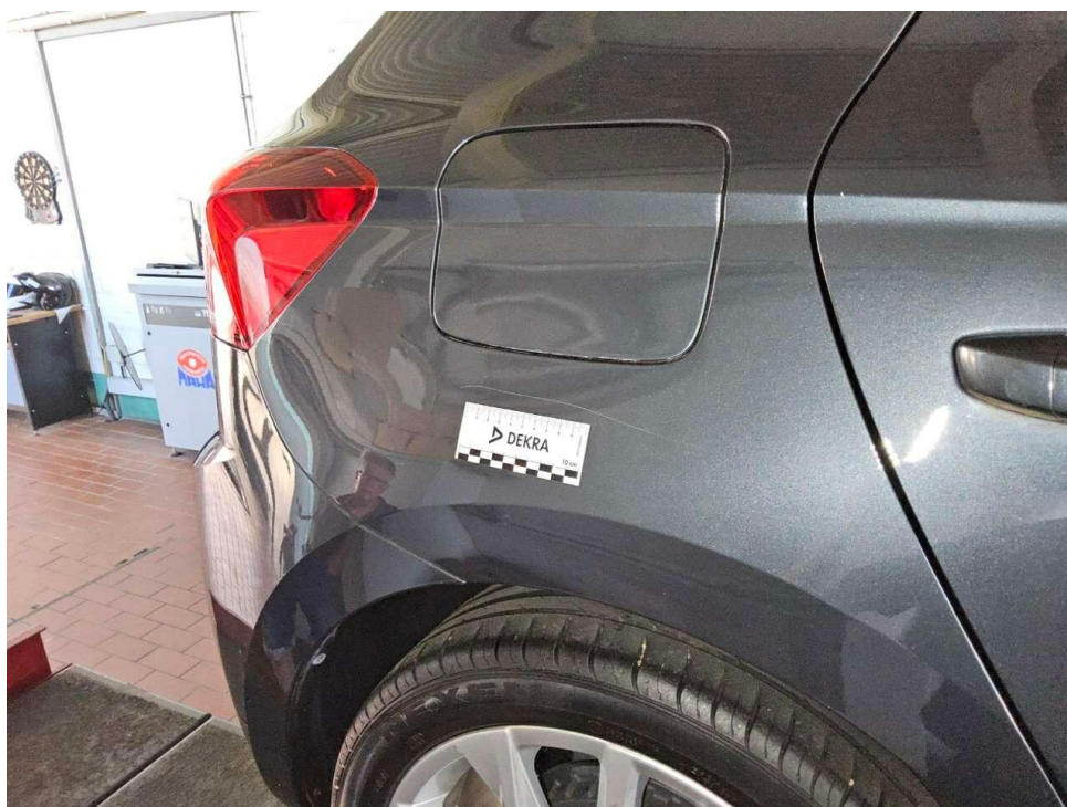
Bild 26 : Seitenteil hinten rechts, deformiert, instandsetzen und lackieren mit Lackaufbau
