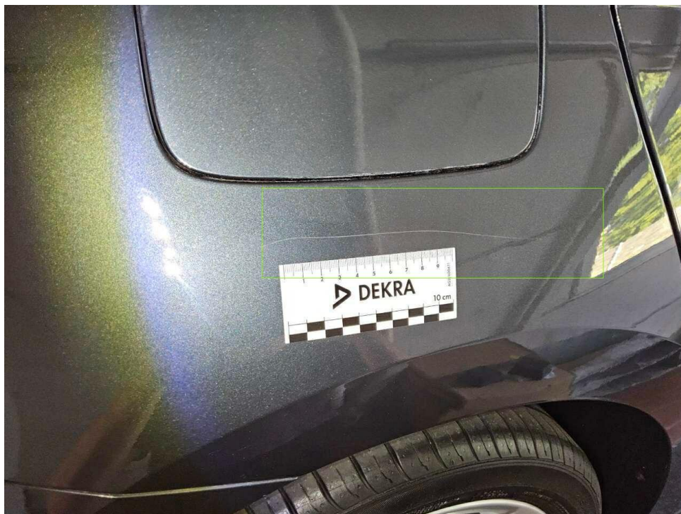
Bild 25 : Seitenteil hinten rechts, deformiert, instandsetzen und lackieren mit Lackaufbau
