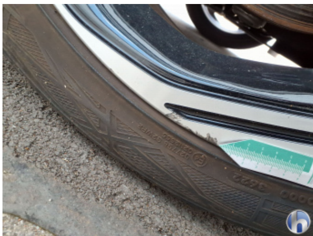
2. Felge Vorne - Rechts Kratzer - Smart Repair
