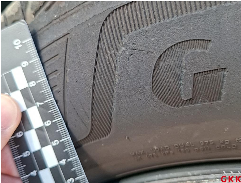
Bild 28 Reifen, vorne rechts, beschädigt, ersetzen
