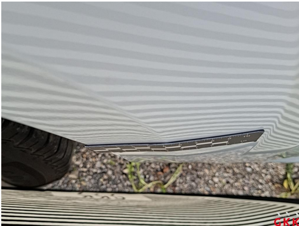
Bild 32 Seitenwand rechts, bis 3 Dellen / Bauteil, Smartrepair
