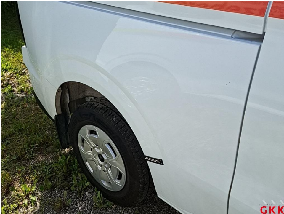
Bild 31 Seitenwand rechts, bis 3 Dellen / Bauteil, Smartrepair
