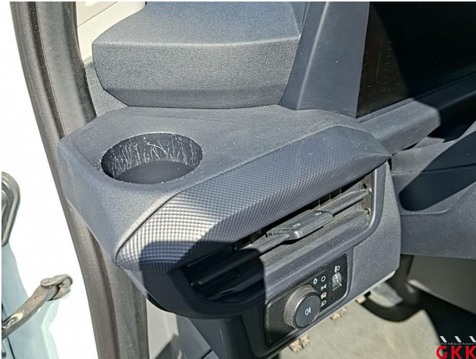
Bild 43 Armaturenbrett, Blende, verkratzt, ersetzen
