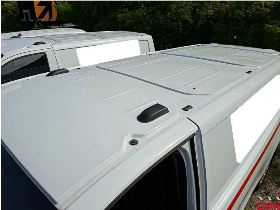
Bild 15 Dach, beschädigt, ersetzen
