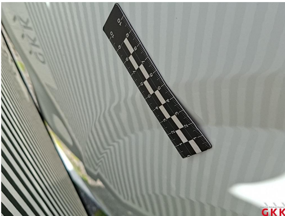
Bild 38 Seitenwand links, beschädigt, instand setzen - lackieren
