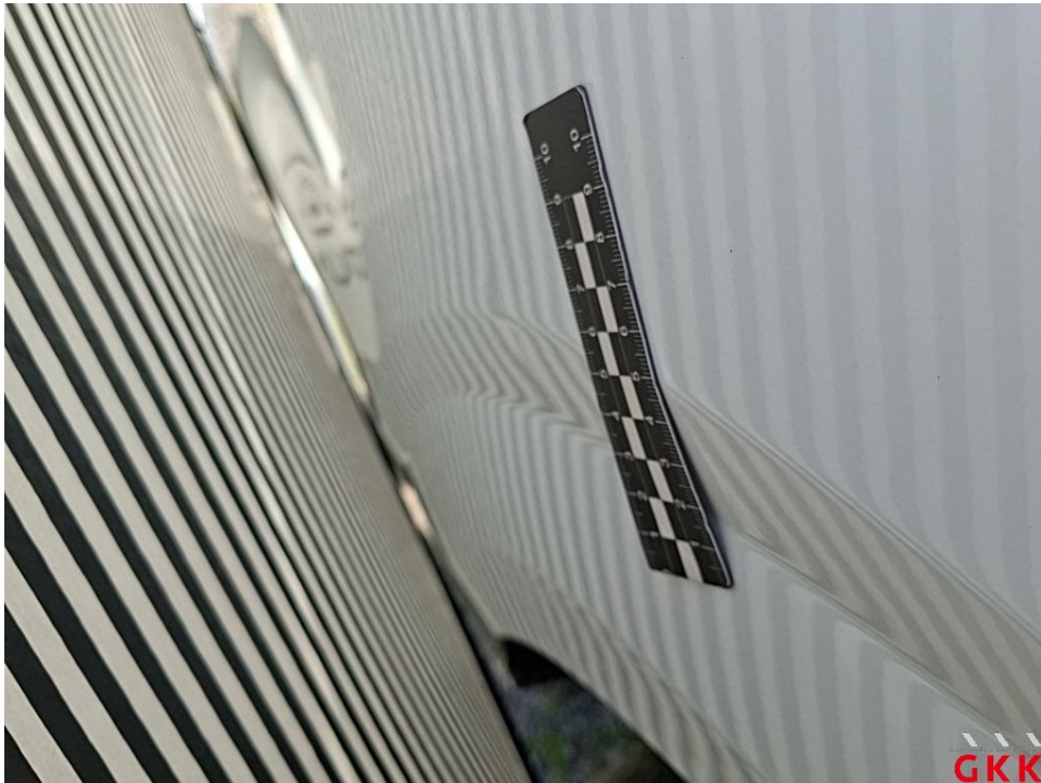
Bild 39 Seitenwand links, beschädigt, instand setzen - lackieren
