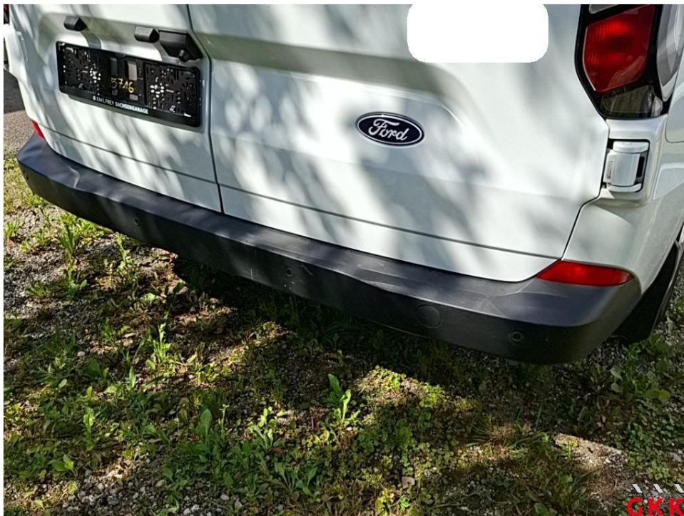
Bild 34 Stoßfänger hinten, Verkleidung unterhalb -unlackiert-, beschädigt, ersetzen
