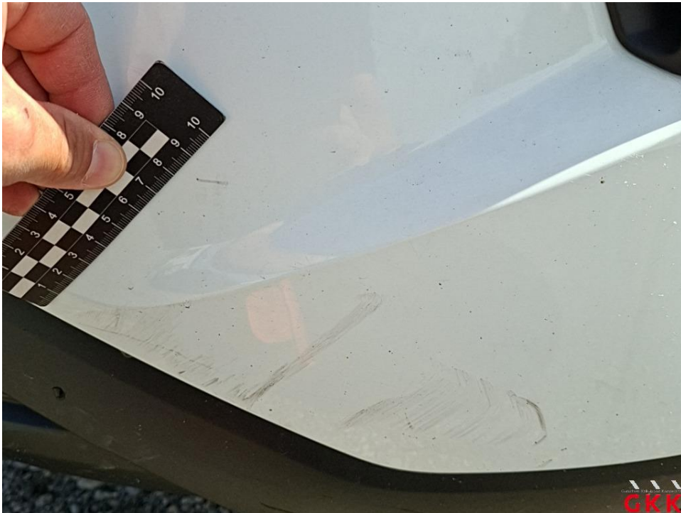
Bild 21 Stoßfänger vorne, Verkleidung oberhalb -lackiert-, verkratzt, lackieren
