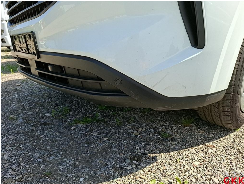
Bild 23 Stoßfänger vorne, Verkleidung unterhalb -unlackiert-, beschädigt, ersetzen
