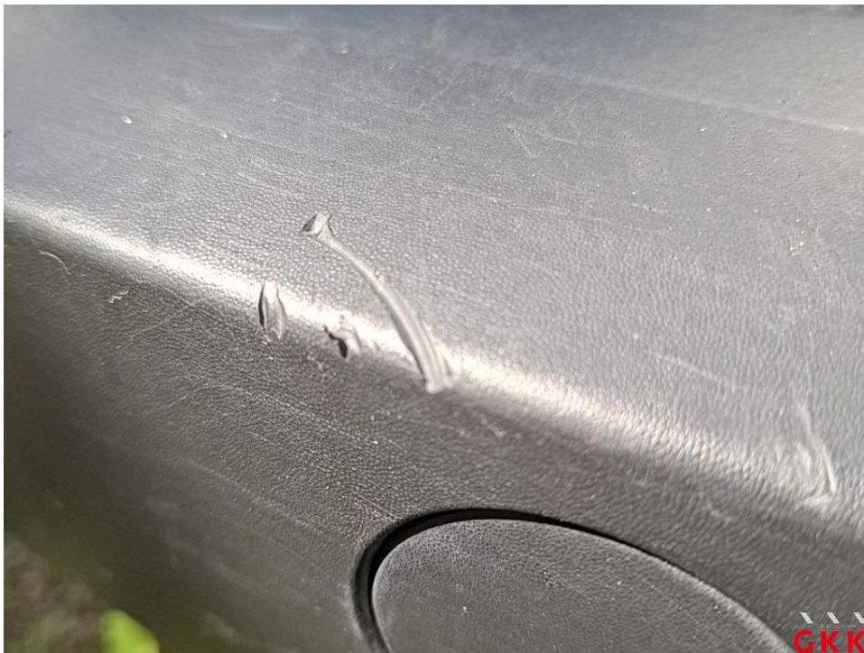
Bild 36 Stoßfänger hinten, Verkleidung unterhalb -unlackiert-, beschädigt, ersetzen
