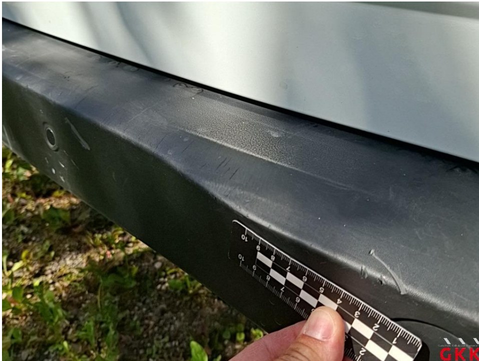
Bild 35 Stoßfänger hinten, Verkleidung unterhalb -unlackiert-, beschädigt, ersetzen
