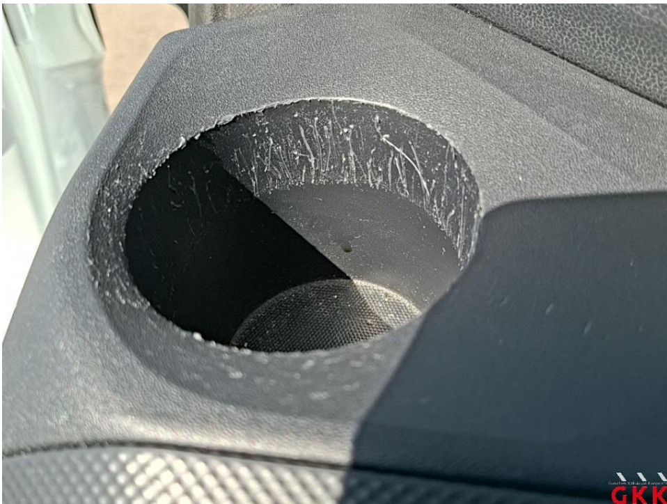
Bild 44 Armaturenbrett, Blende, verkratzt, ersetzen
