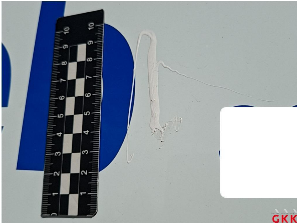
Bild 41 Seitenwand links, Lackierung verätzt, aufbereiten
