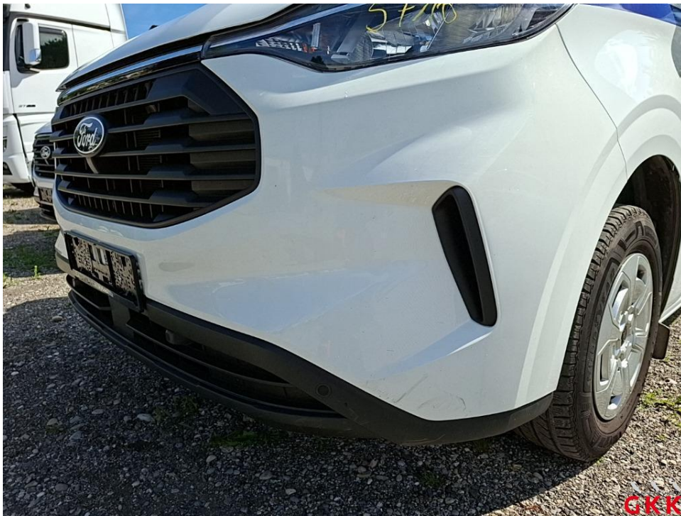
Bild 20 Stoßfänger vorne, Verkleidung oberhalb -lackiert-, verkratzt, lackieren
