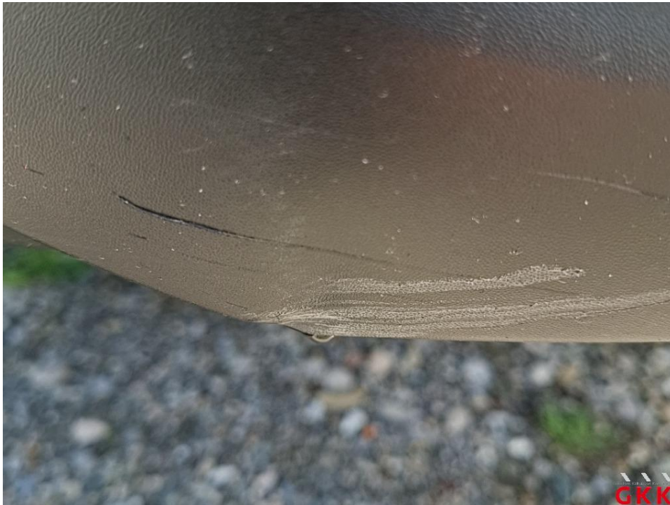
Bild 25 Stoßfänger vorne, Verkleidung unterhalb -unlackiert-, beschädigt, ersetzen
