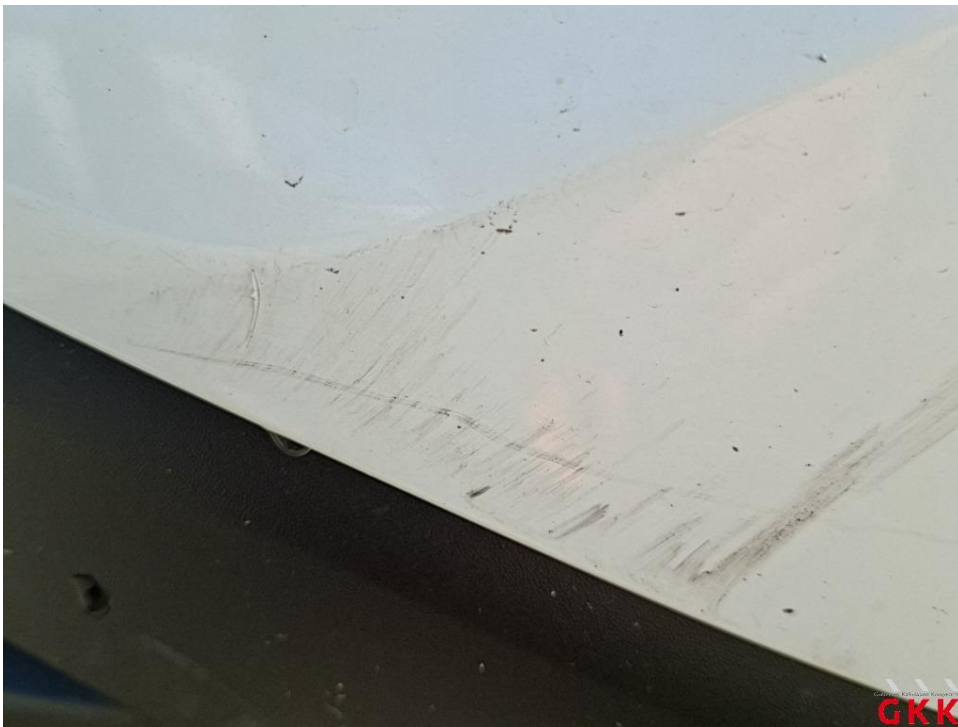
Bild 22 Stoßfänger vorne, Verkleidung oberhalb -lackiert-, verkratzt, lackieren
