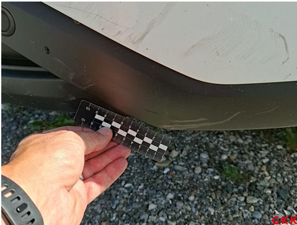
Bild 24 Stoßfänger vorne, Verkleidung unterhalb -unlackiert-, beschädigt, ersetzen
