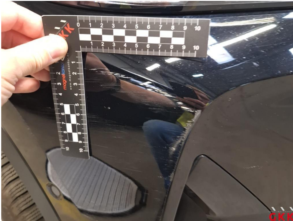
Bild 19 Stoßfänger vorne, Verkleidung oberhalb -lackiert-, verkratzt, lackieren
