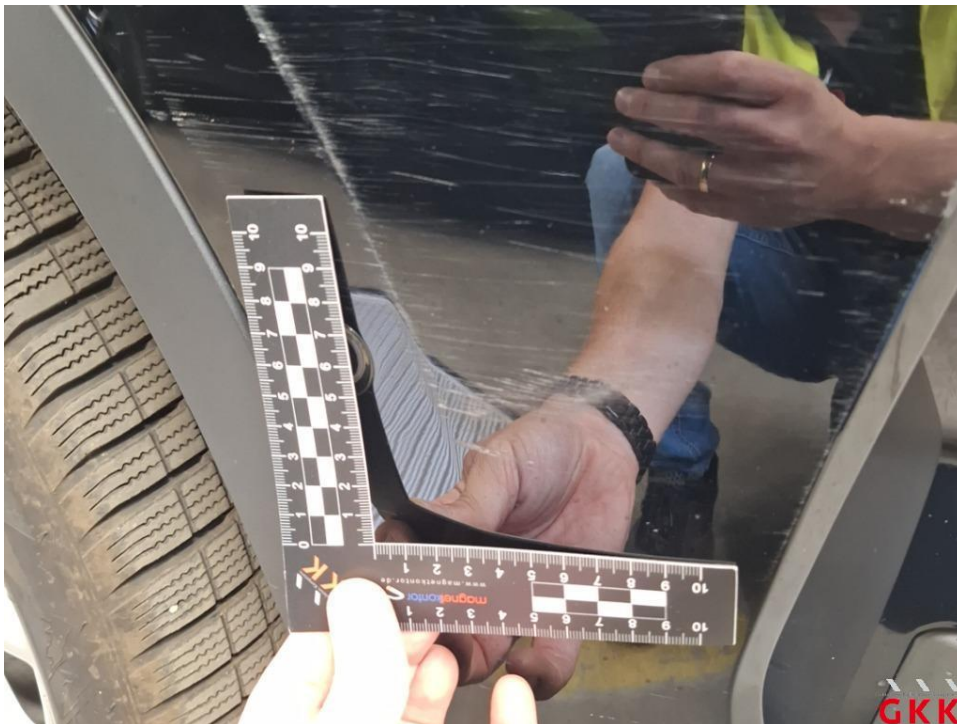
Bild 20 Stoßfänger vorne, Verkleidung oberhalb -lackiert-, verkratzt, lackieren
