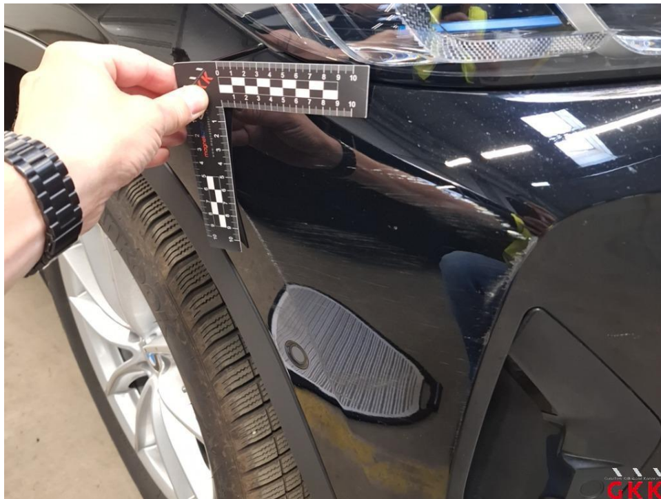
Bild 18 Stoßfänger vorne, Verkleidung oberhalb -lackiert-, verkratzt, lackieren
