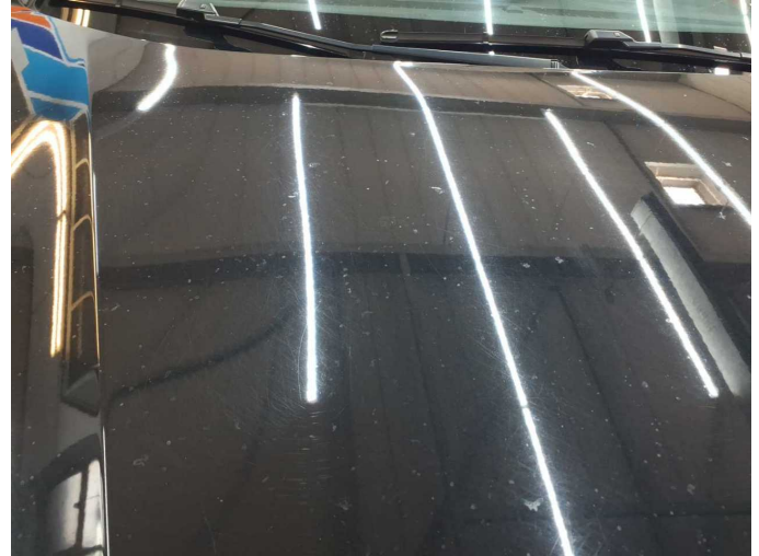
Damage 5: Bonnet: Bonnet (Verätzungen,-Mehrkosten möglich) - Paint defect - Conditioning
