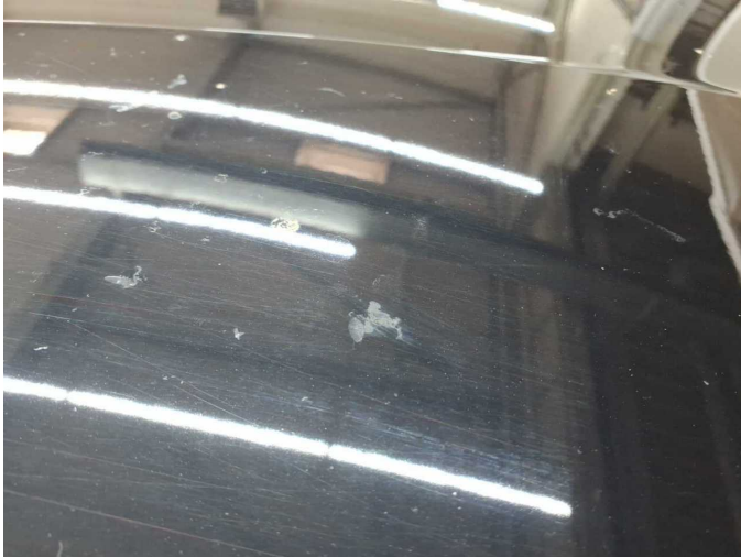
Damage 8: Roof: Roof (Verätzungen, -Mehrkosten möglich) - Paint defect - Conditioning
