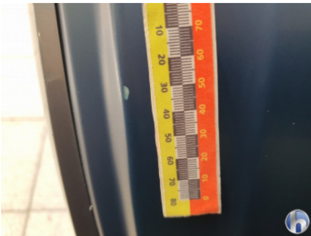
1. Türeinstieg Hinten - Rechts Kratzer - Smart Repair
