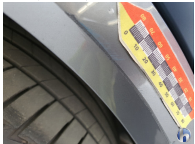
5. Zierleiste Vorne - Rechts Kratzer - Smart Repair
