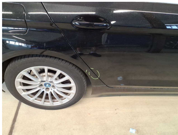
Beschädigung #2: Seitenwand rechts: Seitenwand - Delle(n) - sanft instandsetzen
