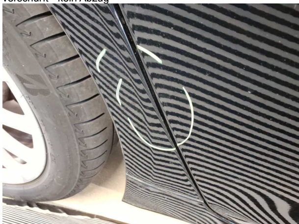
Beschädigung #2: Seitenwand rechts: Seitenwand - Delle(n) - sanft instandsetzen
