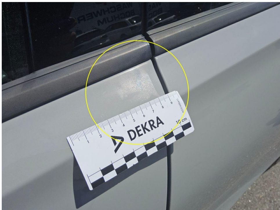
Bild 14 : Restspuren Reparaturlackierung Tür vorne links
