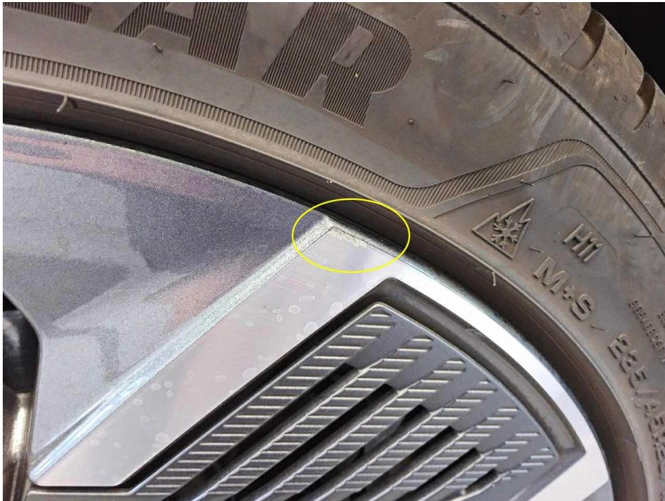
Bild 15 : Felge hinten rechts verschrammt (Glanzgedreht)
