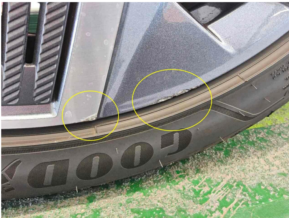
Bild 16 : Felge hinten rechts verschrammt (Glanzgedreht)
