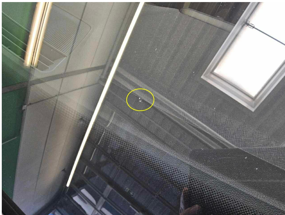
Bild 19 : Frontscheibe Steinschläge ohne Rissbildung
