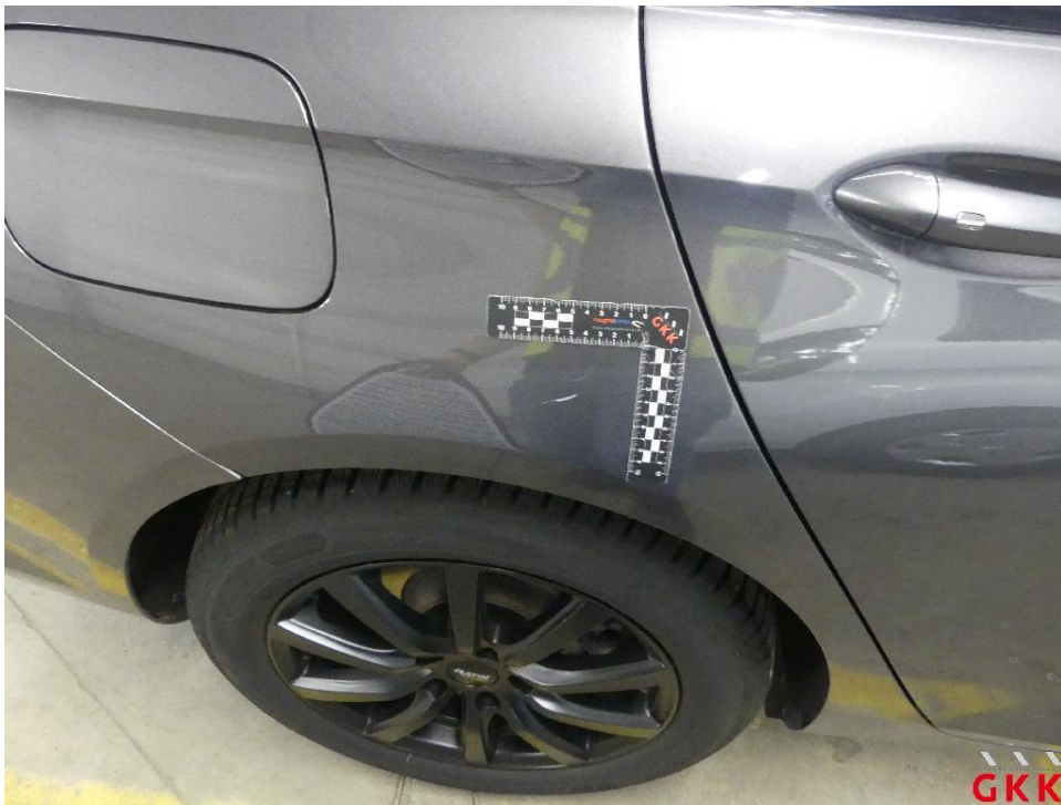
Bild 24 Seitenwand rechts, beschädigt, instand setzen - lackieren
