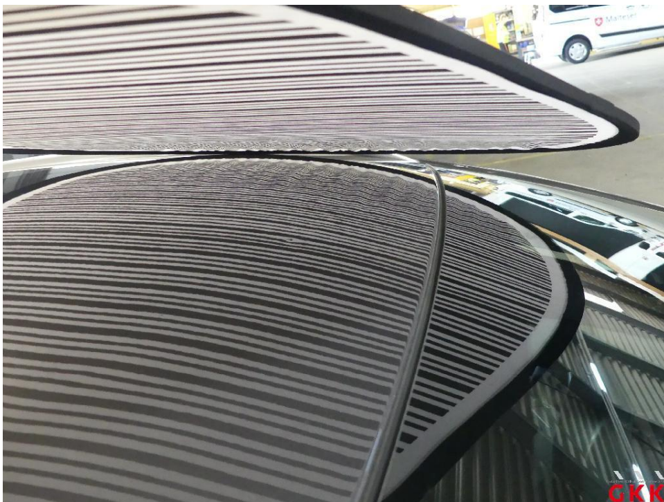
Bild 20 Fahrzeug, Hagelschaden, kalt drücken
