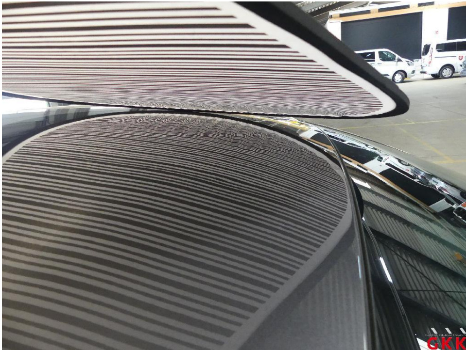
Bild 19 Fahrzeug, Hagelschaden, kalt drücken
