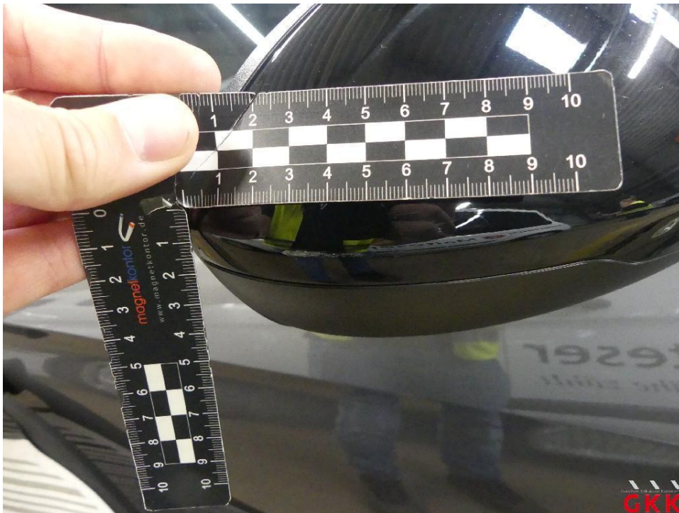
Bild 17 Spiegelgehäuse rechts, Kappe -lackiert-, verkratzt, lackieren ohne LV
