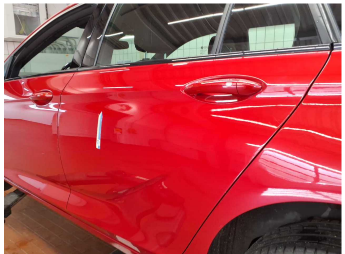
Damage 10: Door - rear left side: Door - Scratch(es) - Paint
