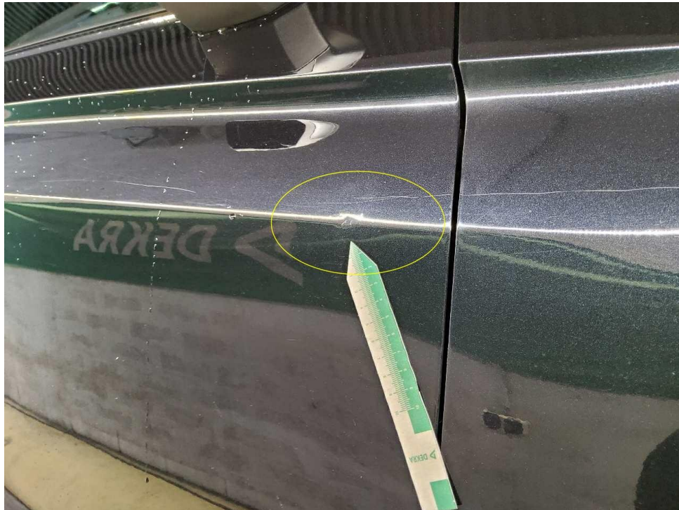
Bild 19 : Tür vorn rechts eingedellt
