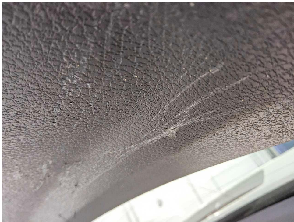
Bild 26 : Heckklappenverkleidung stark zerkratzt
