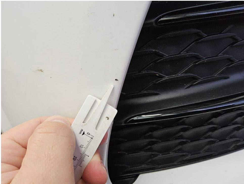
Bild 28 : Stoßfänger vorne, Steinschlag, Gebrauchsspur
