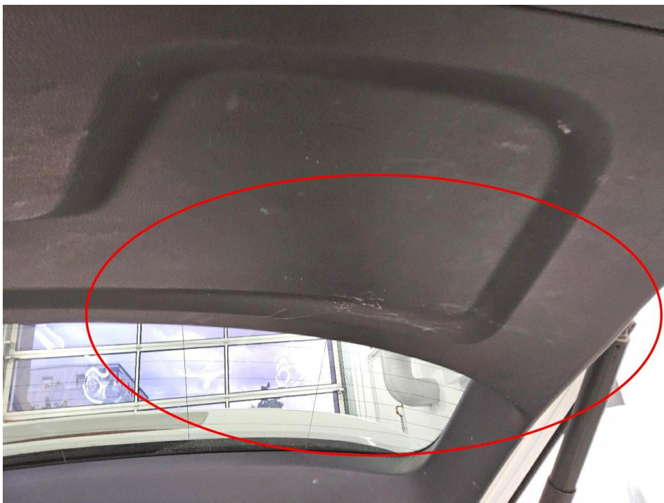
Bild 25 : Heckklappenverkleidung stark zerkratzt
