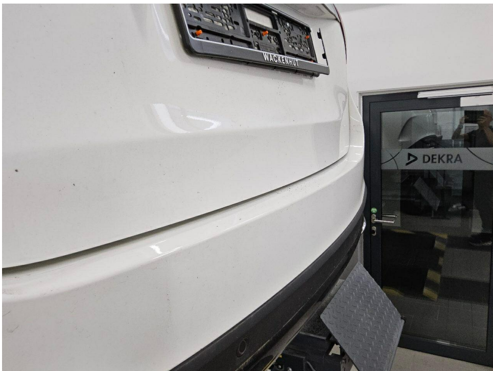
Bild 29 : Stoßfänger hinten, Kratzer, Gebrauchsspur
