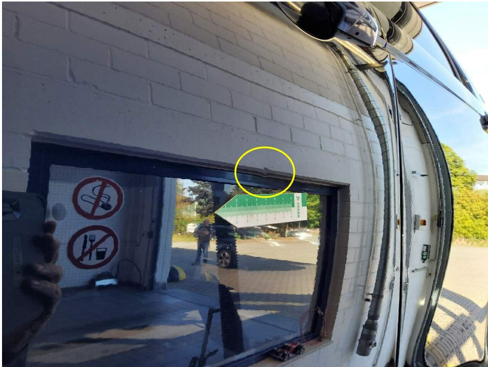
Bild 14 : Tür vorne links, eingedellt, Gebrauchsspur
