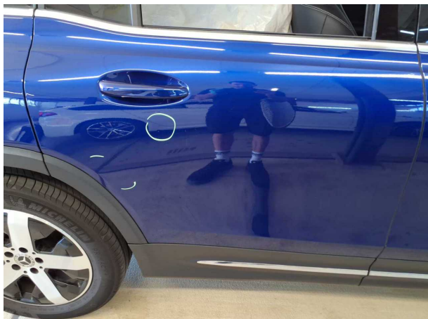
Beschädigung #2: Tür hinten rechts: Tür - Delle / Lackschaden - auslegen / polieren
