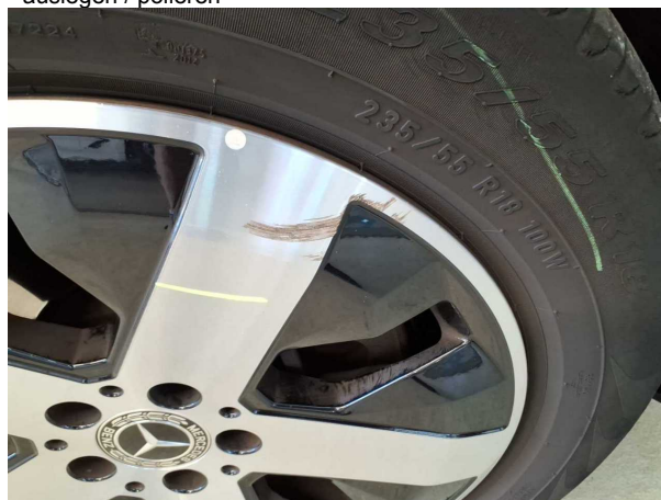
Beschädigung #4: Rad/Reifen: Leichtmetallfelge vorn rechts - verkratzt / verschürft - Wertminderung
