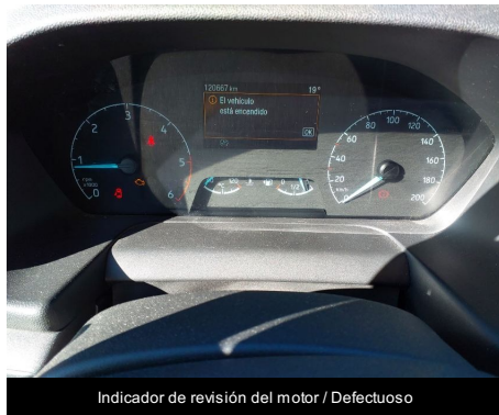
Indicador de revisión del motor / Defectuoso
