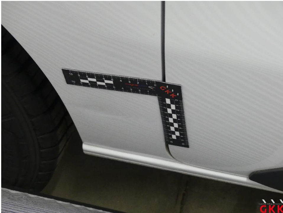
Bild 21 Seitenwand rechts, beschädigt, instand setzen - lackieren
