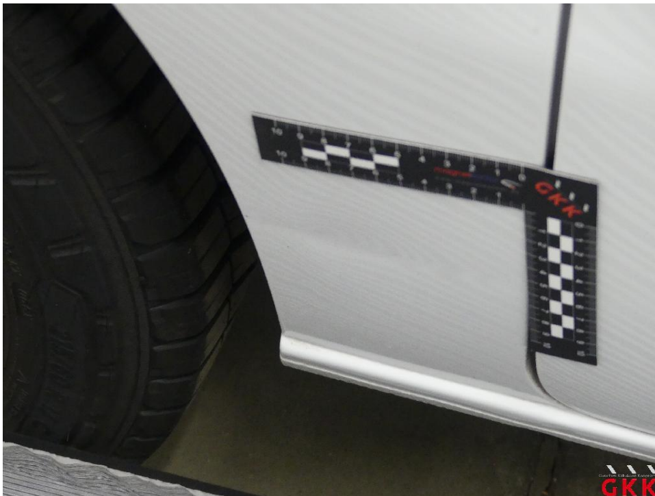
Bild 20 Seitenwand rechts, beschädigt, instand setzen - lackieren
