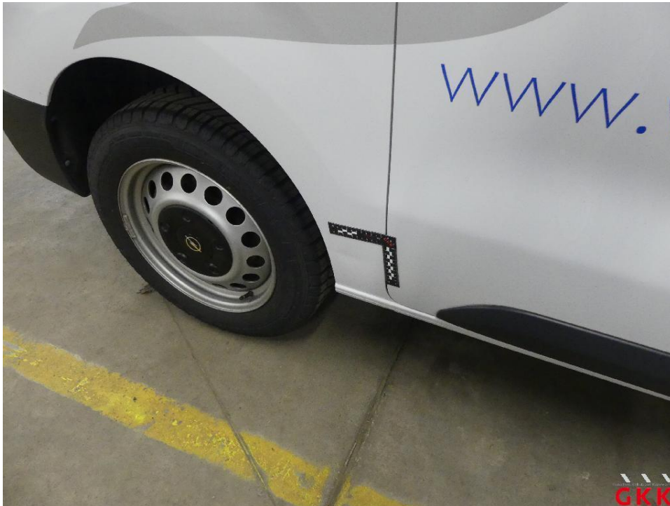
Bild 19 Seitenwand rechts, beschädigt, instand setzen - lackieren
