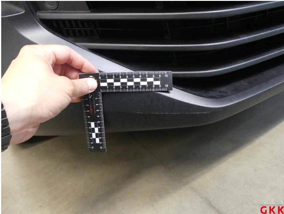
Bild 13 Stoßfänger vorne, Verkleidung -unlackiert-, verkratzt, ersetzen
