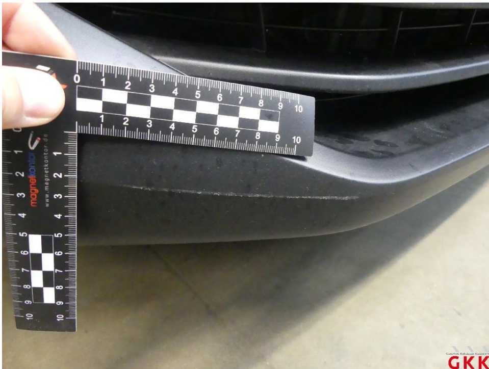
Bild 14 Stoßfänger vorne, Verkleidung -unlackiert-, verkratzt, ersetzen
