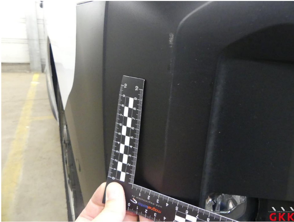
Bild 15 Stoßfänger vorne, Verkleidung -unlackiert-, verkratzt, ersetzen
