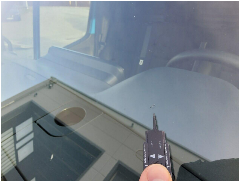
Bild 9 : Frontscheibe Steinschlag mit Rissbildung
