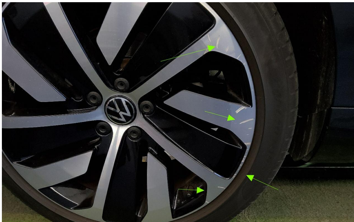
Bild 16 : Alufelge (Sommer glanzgedreht) hinten rechts verschrammt
