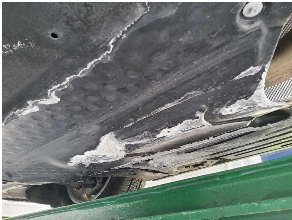
Bild 25 : Undichtigkeit am Unterboden
