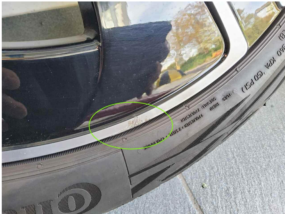
Bild 23 : Leichtmetallrad Glanzgedreht vorne links verschrammt
