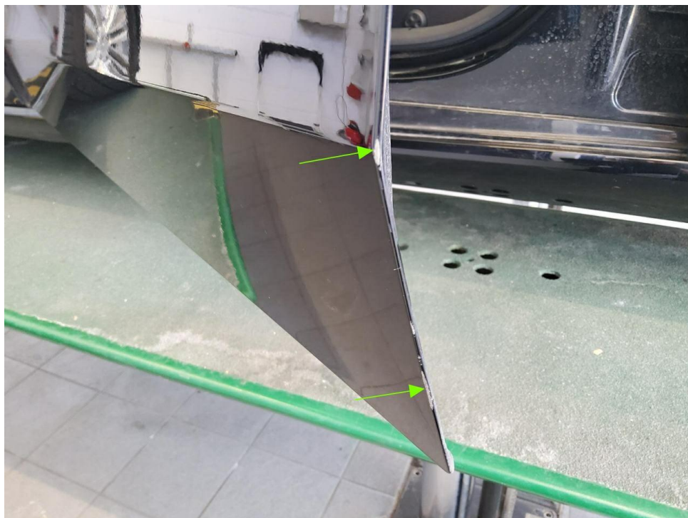
Bild 18 : Tür vorne links Türkante, verschrammt, Gebrauchsspur
