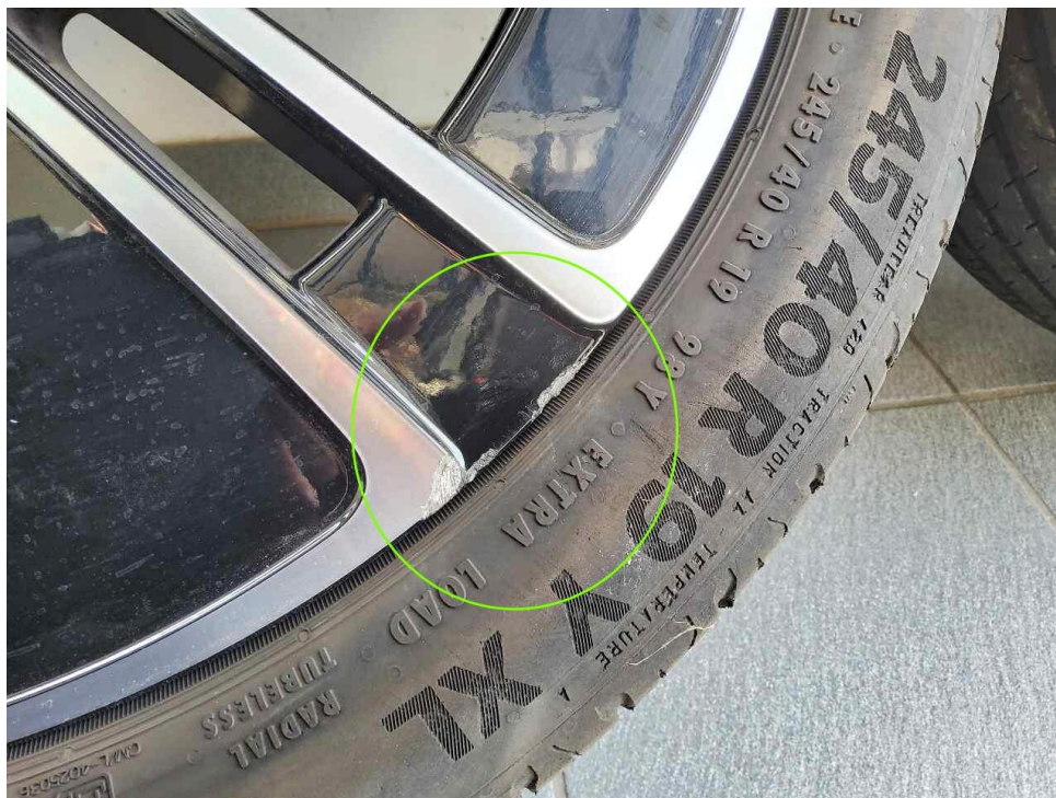
Bild 21 : Leichtmetallrad Glanzgedreht vorne rechts verschrammt
