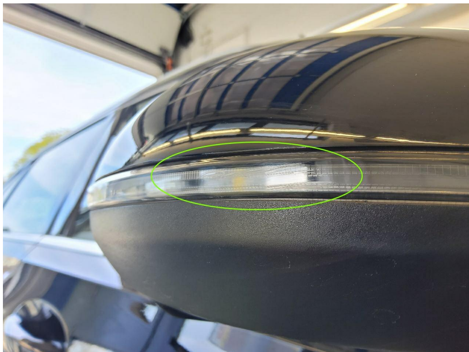
Bild 24 : Blinkerglas rechts verschrammt
