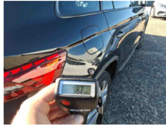
Lackstärke Seitenwand hinten rechts
